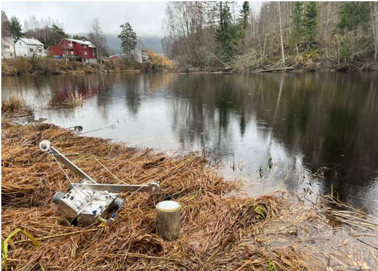
Figur 4. Prøvetaking av mikroplast i Simoa (Modum) med grabb. Kun metallutsyr ble benyttet til prøvetaking av mikroplast.
