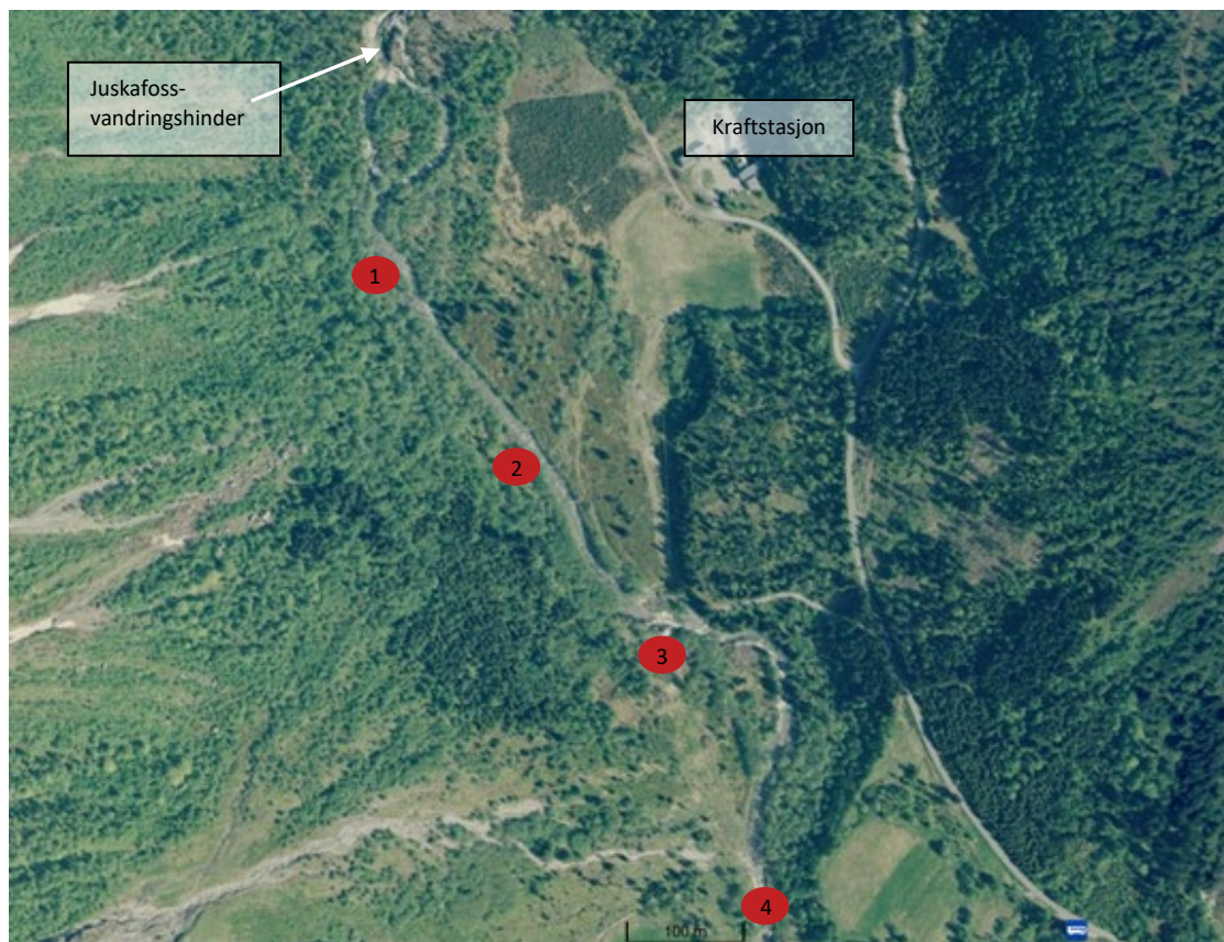
Figur 10. Oversikt over de fire lokalitetene hvor det ble lagt ut gytegrus. Moderate terrengjusteringer ble utført for å sikre gytegrusen bedre mot utspyling ved stor flom på områdene.
