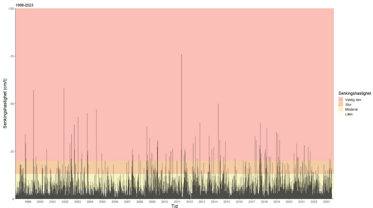
Figur 6. Senkningshastigheter, dvs. reduksjon i vannstand fra en time til neste i perioden 1998 - 2023 nedstrøms Vigeland kraftverk. Fargeskalaen indikerer grenseverdier for klassifisering av effekt fra Bakken mfl. (2016).
