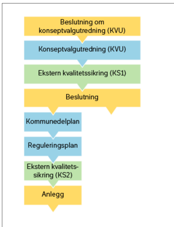
Figur 1 Prosess for kvalitetssikring og bygging av store investeringsprosjekter Kilde: Statens Vegvesen
