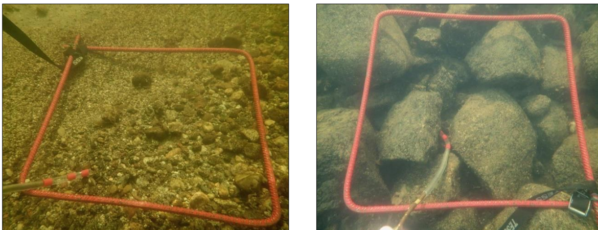
Figur 6. Skjulforhold for ungfisk måles ved å kvantifisere antall og størrelse på hulrom i elvebunnen med en plastslange innenfor en rute på 0,25 m 2 . Slangen har røde markører som brukes til å måle hulrommenes dybde. Eksempel på skjulmålinger i substrat med mye fin grus og sand hvor det ikke finnes hulrom, og dermed svært lite skjul (t.v.), og i substrat med stein/blokk som gir mye skjul (t.h.).
