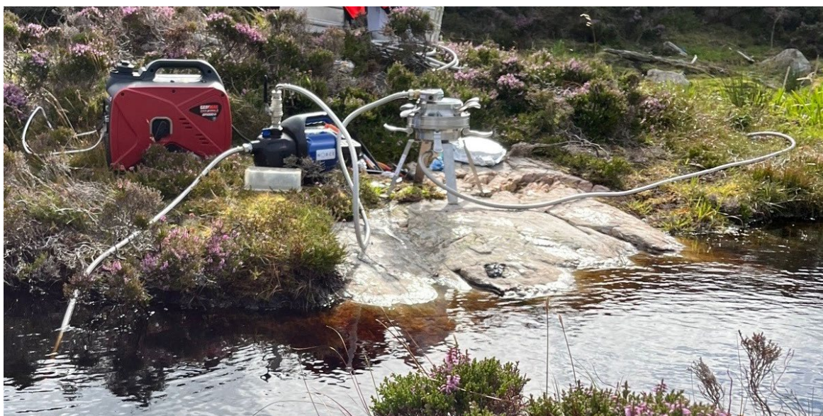
Bildeserie 5. Oppsett av vannprøvetakningen for mikroplast (2022). Øverst: filterholder i syrefast stål. Under fra venstre: Dieselgenerator (rød), membranpumpe (blå), tilknyttet prøvetaingsslange, og slange til filterholder i stål. Avløpsslange (med volumeter) slipper filtrert vann ut i bakkant av området for ikke å påvirke prøven. (Foto: Marte Haave).
