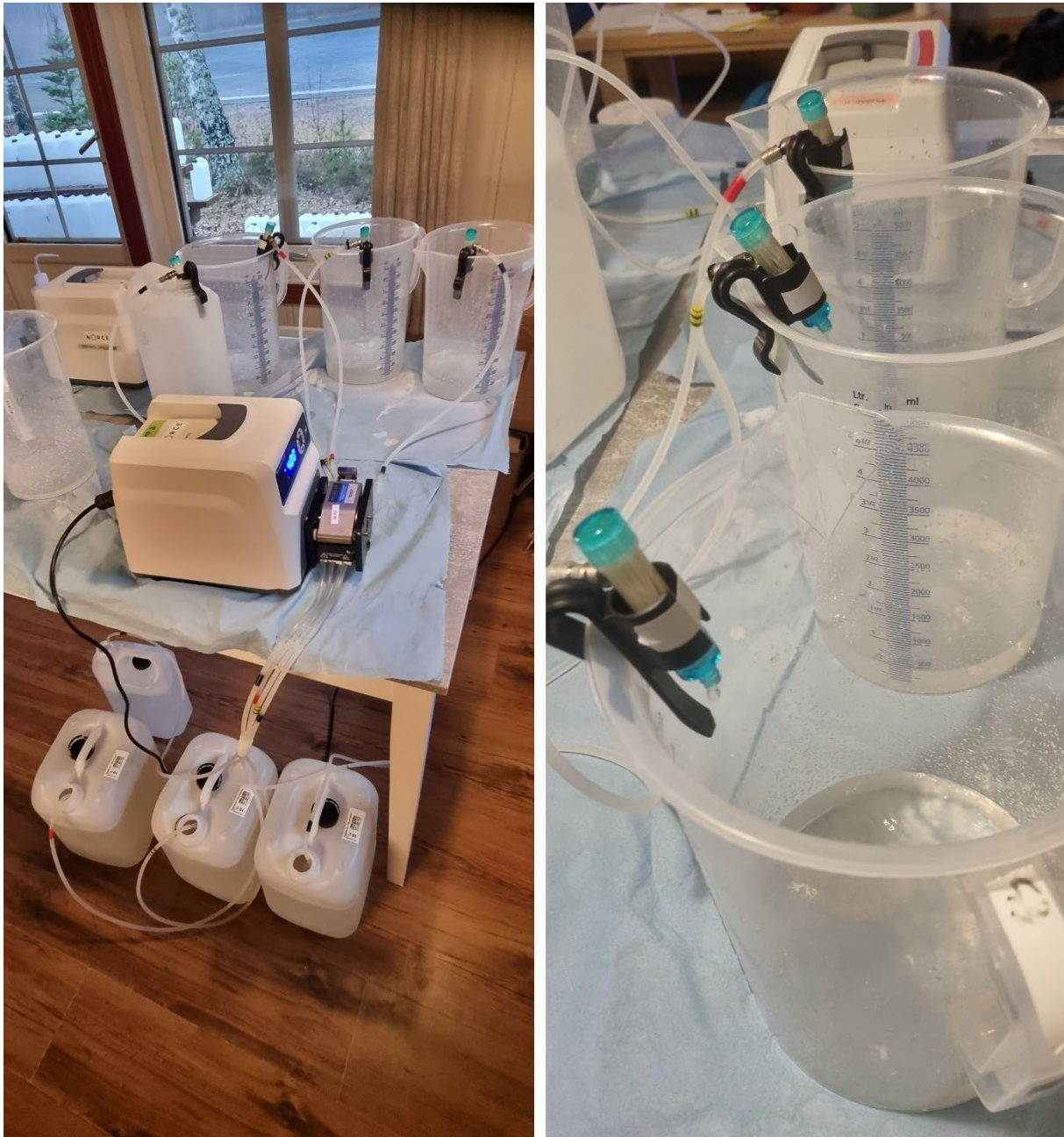
Foto 1. Filtreringsoppsett med bruk av peristaltiske pumper og innkapslede filter.
