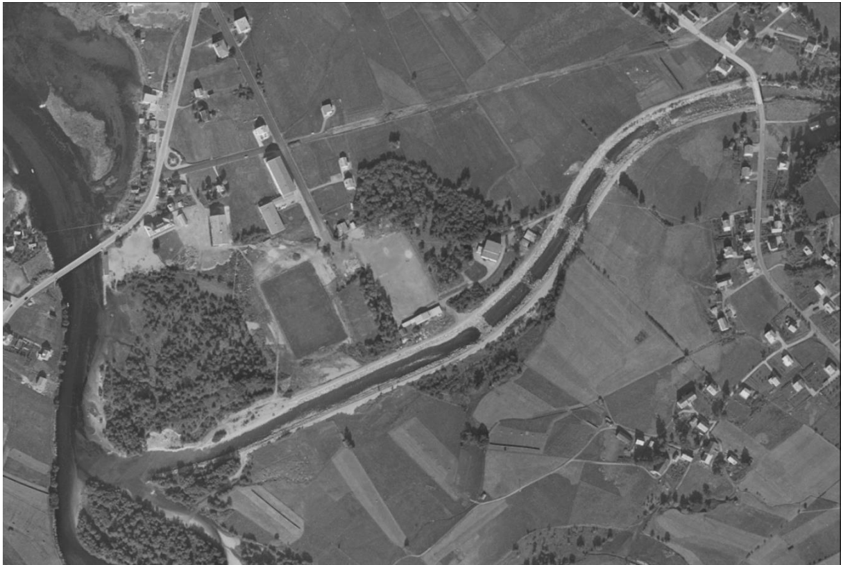
Figur 48. Flyfoto av Rossåna fra 1961, kort tid etter kanaliseringen, hvor man også tydelig ser tersklene som ble etablert.
