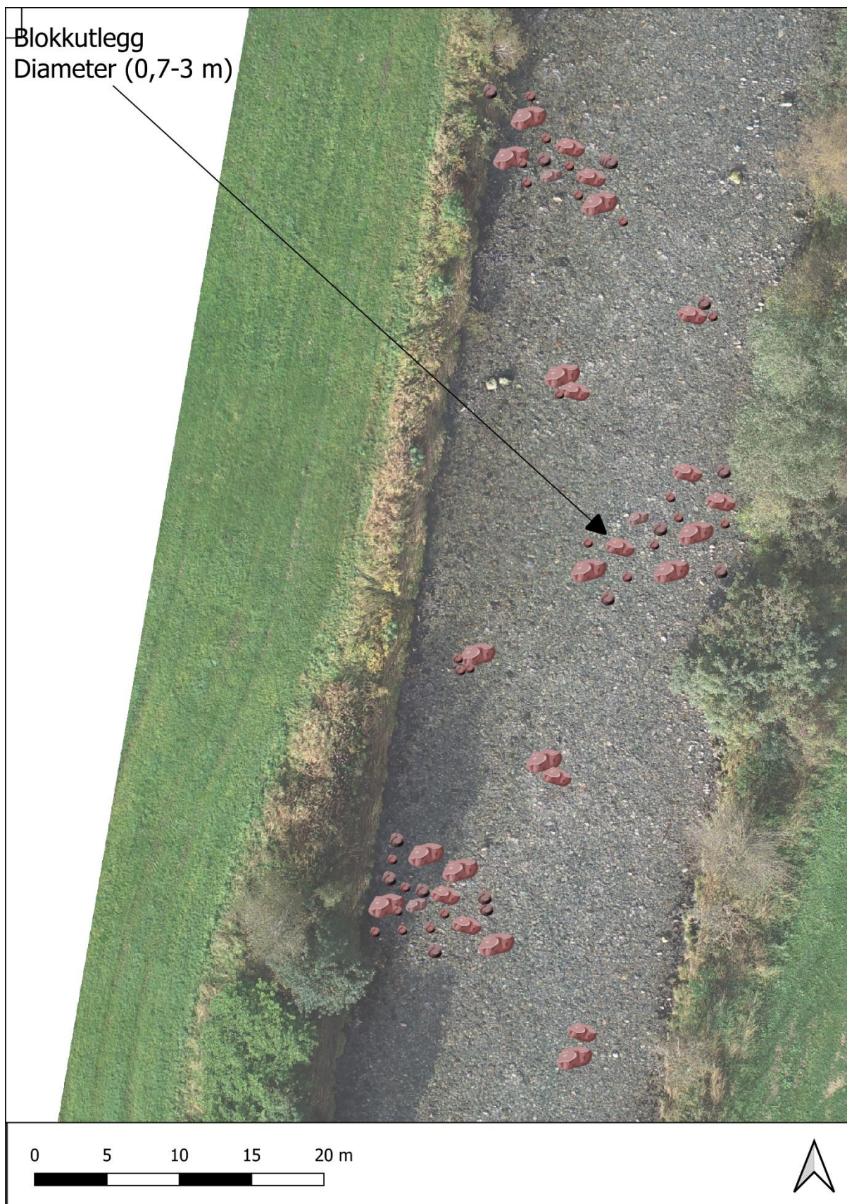
Figur 65. Tiltaksforslag for øvre del av kanalisert strekning i Follestadalselva dersom elveløpet ikke utvides. Strekningen mangler i dag gyteområder og standplasser for voksen fisk. Se kapittel 7.3 i «Tiltakshåndboka» (Pulg mfl. 2018) for et eksempel på lignende tiltak i Frafjordelva.
