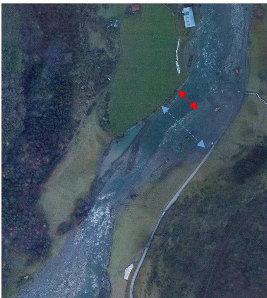
2014, november etter flommen , Aktiv elveløp: 44 m bredde Aktiv elveslette, lys pil: 85 m bredde
