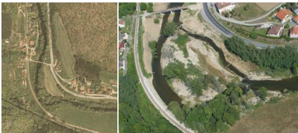
Figur 16. Restaurering av vassdrag og elveslette inkl. våtmark og myr. Eksempel Kamp/Østerrike. Bildet viser en utvidelse av elveløp og elveslette som oppsto i en flom og som ble opprettholdt etterpå som flomsikringstiltak for å redusere både erosjonsrisiko og oversvømmelsesfare for bebyggelsen rundt.
