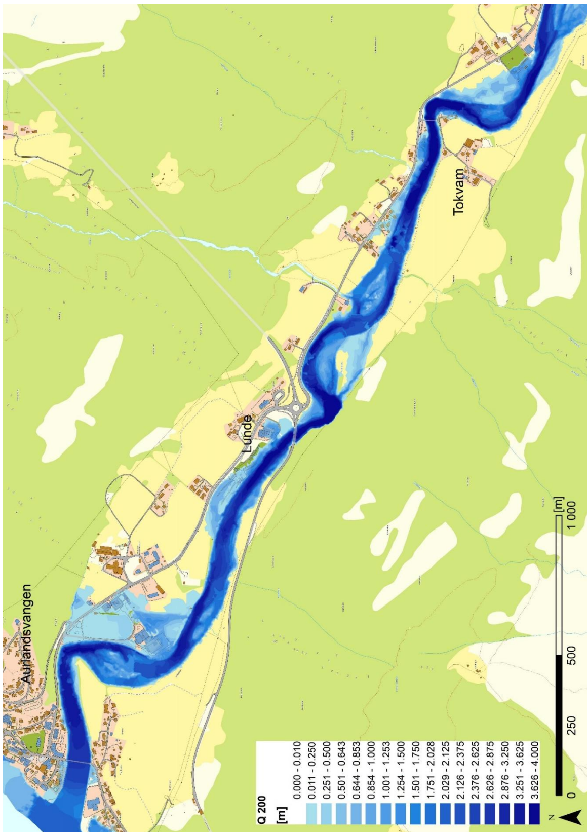
Figur 72. Nedre Aurlandselva med modellert vannstand ved 200-årsflom.
