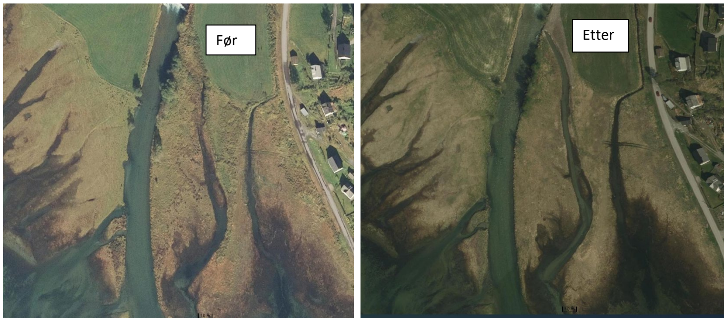
Figur 30. Sideløp i elvedeltaet ble gjenåpnet ved å lage en åpning i forbygningen i hovedelven rett nedstrøms terskelen og ved å grave ut et nytt løp i øvre del av sideløpet. Det ble lagt ut blokker i sideløpet for å skape bedre leveområder for ungfisk.
