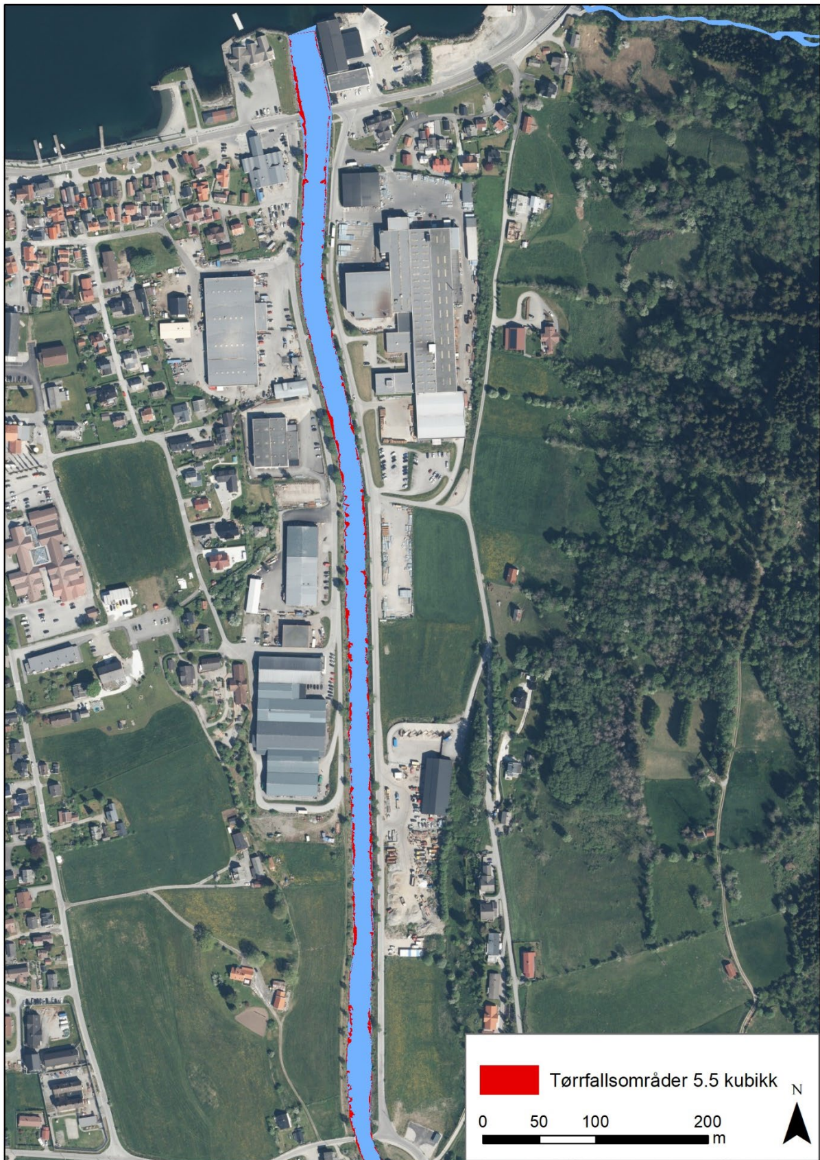
Figur 25. Tørrlagt areal i nedre del i anadrom strekning av Vikja nedstrøms Hove kraftverk ved 5 \text{ m}^3/\text{s} . Blå del av elva er vanddekt areal, mens røde områder er tørrlagt. Normalt er minstevannføring på 5,5 \text{ m}^3/\text{s} ved drift av ett aggregat eller på 2 \text{ m}^3/\text{s} ved full stans av kraftverket.
