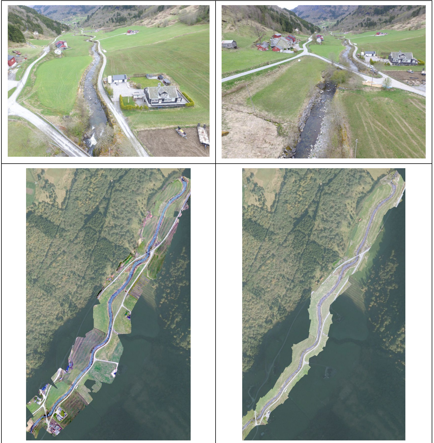
Figur 17. Vanddekning på strekningen oppstrøms og nedstrøms Ovrisdal bru ved 200 l/s (venstre) og ved 100 l/s (høyre). Vanddekt areal ble beregnet å være 7710 m 2 ved 200 l/s og 7244 m 2 ved 100 l/s.
