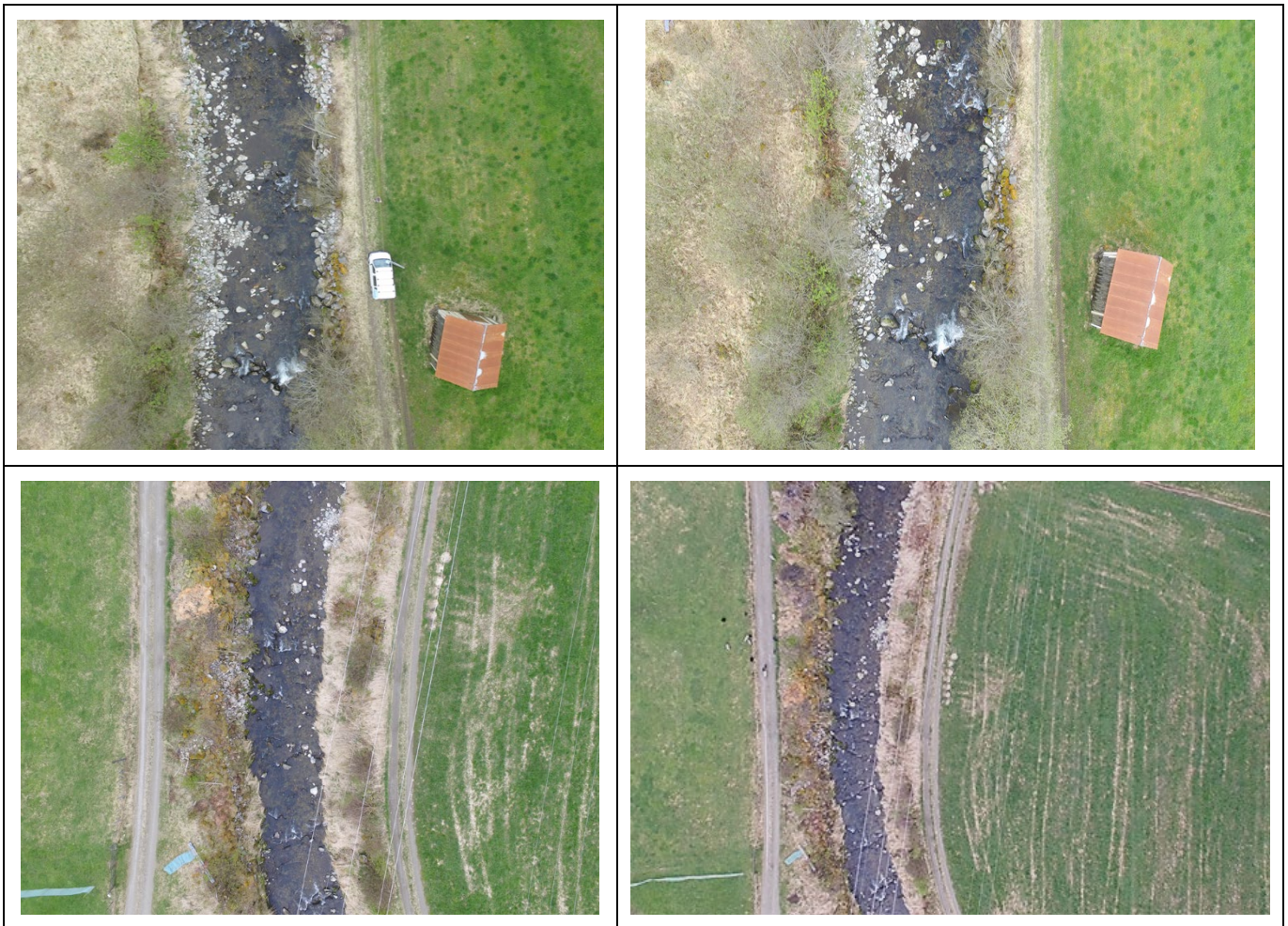
Figur 19. Uvalgte strekninger på Hesjasletta som viser forskjellen i vanddekt areal ved 100 l/s (venstre) og 200 l/s (høyre).
