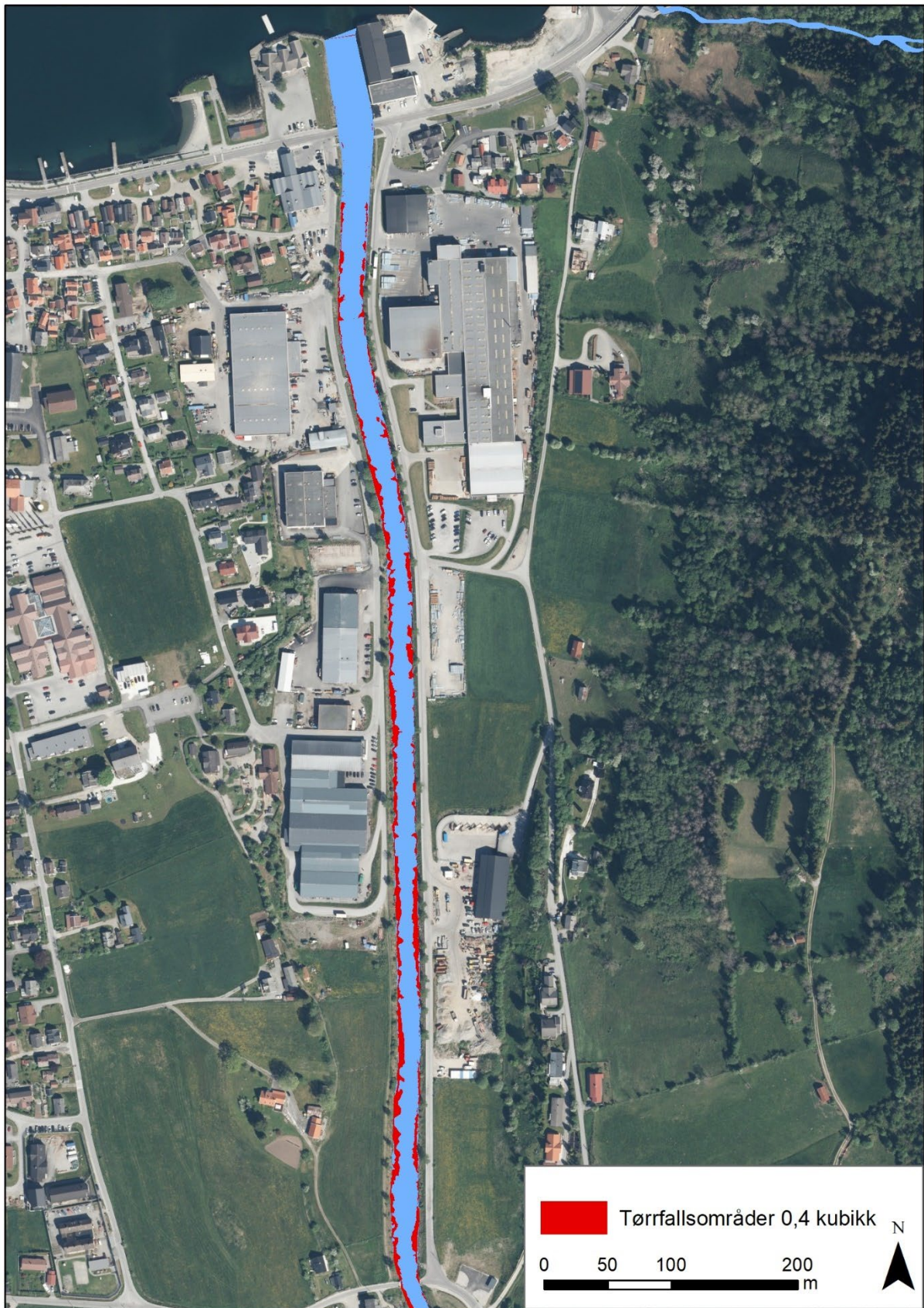
Figur 23. Tørrlagt areal i nedre del i anadrom strekning av Vikja nedstrøms Hove kraftverk ved 0,4 \text{ m}^3/\text{s} . Blå del av elva er vanddekt areal, mens røde områder er tørrlagt. Normalt er minstevannføring på 5,5 \text{ m}^3/\text{s} ved drift av ett aggregat eller på 2 \text{ m}^3/\text{s} ved full stans av kraftverket.
