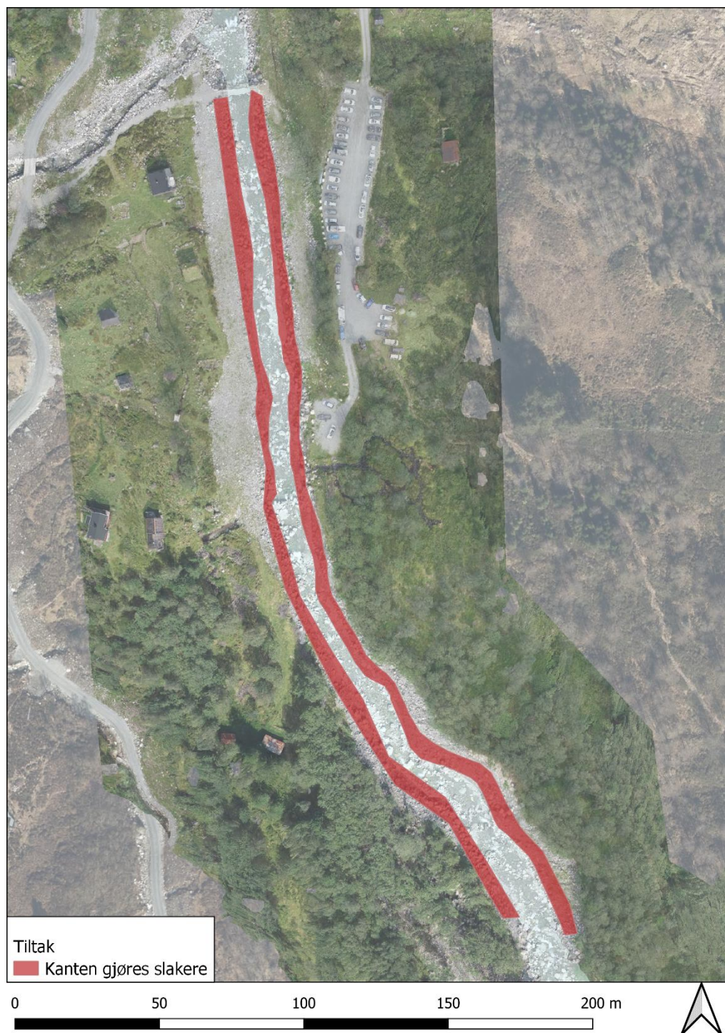
Figur 17. Tiltaksskisse for strekningen ved Barstadsætra.
