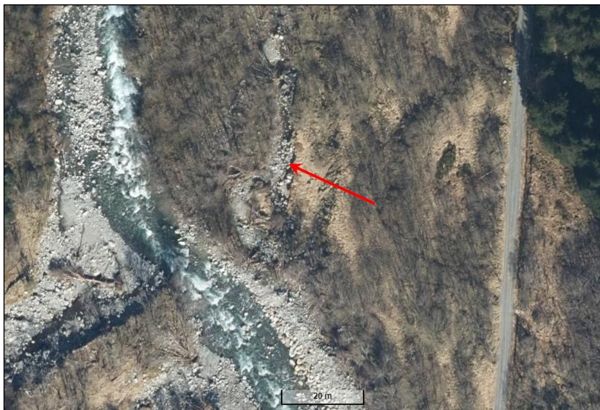
Figur 21. Pilen indikerer hvor en kort grøft kan graves for å lede vann fra en liten bekk ned i sideløp B.
