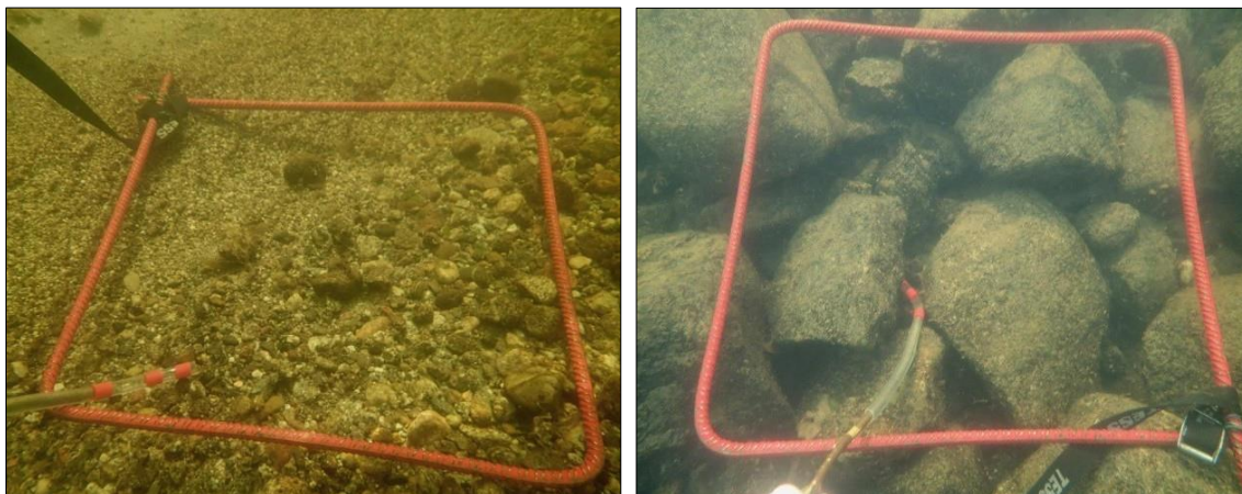
Figur 7. Skjulforhold for ungfisk måles ved å kvantifisere antall og størrelse på hulrom i elvebunnen med en 13 mm tykk plastslange innenfor en rute på 0,25 m 2 . Slangen har røde markører som brukes til å måle størrelsen (dybden) av hulrommene. Eksempel på skjulmålinger i substrat med mye fin grus og sand hvor det ikke finnes hulrom (t.v.), og i substrat med stein/blokk som gir mye skjul (t.h.).
