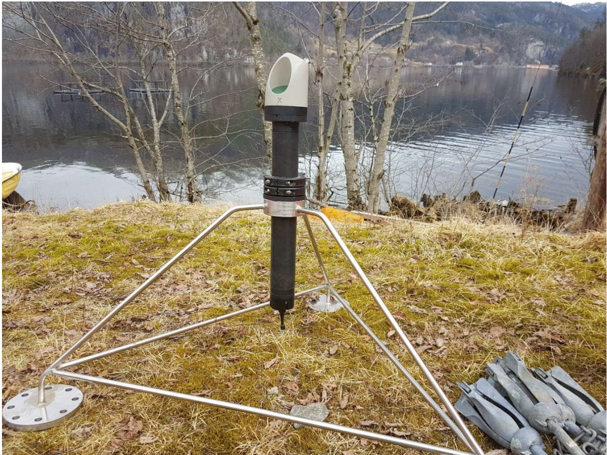
Figur 2.5 ADCP (akustisk profilerende dopplerinstrument, Nortek) montert i bunnramme. Instrumentet var innstilt til å måle strømrretninger og –hastigheter for hver meter oppover i vannsøylen.
