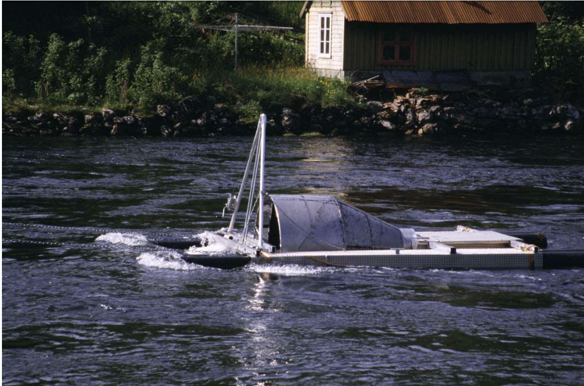
Foto 2. Smoltskruen i drift i Bolstadhølen. Smolten fanges inn i trommelen i front og holdes i et oppbevaringskammer synlig på bakre del av flåten.
