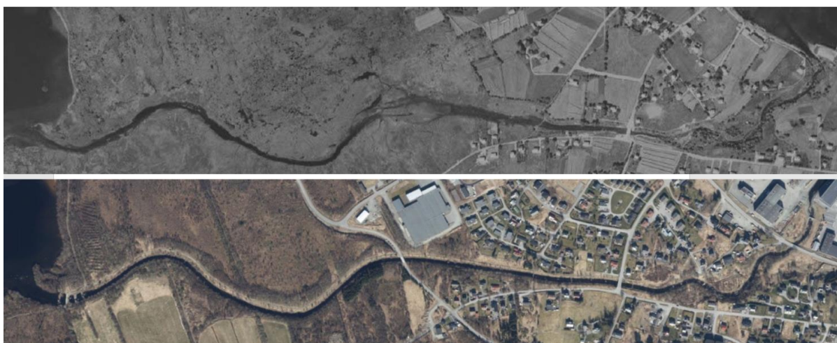
Figur 9. Flyfoto av Hareidselva i 1965 før kanalisering (øverst) og i 2019 etter kanalisering (nederst) ( www.norgebilder.no ).
