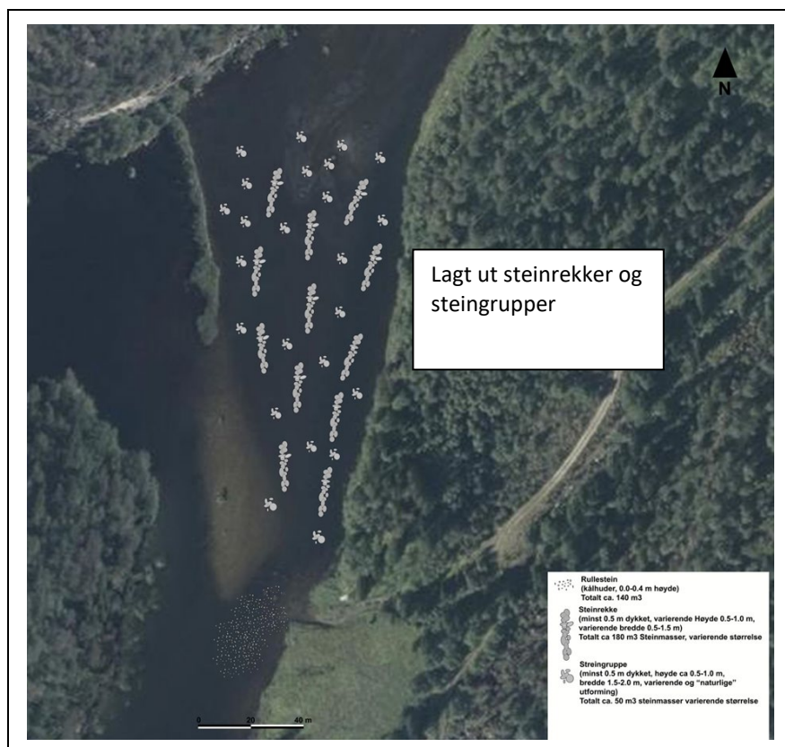
Figur 25. Prinsippskisse for habitattiltak (miljødesign) ved bruk av steingrupper og steinrekker på Fetet i restfeltet i Ekso. En viktig egenskap ved dette tiltaket er at hulrommene har vist seg å bli opprettholdt over tid og ikke sedimentere igjen. Denne formen for tiltak kan også være aktuelt i Vosso for å øke fiskeproduksjonen.
