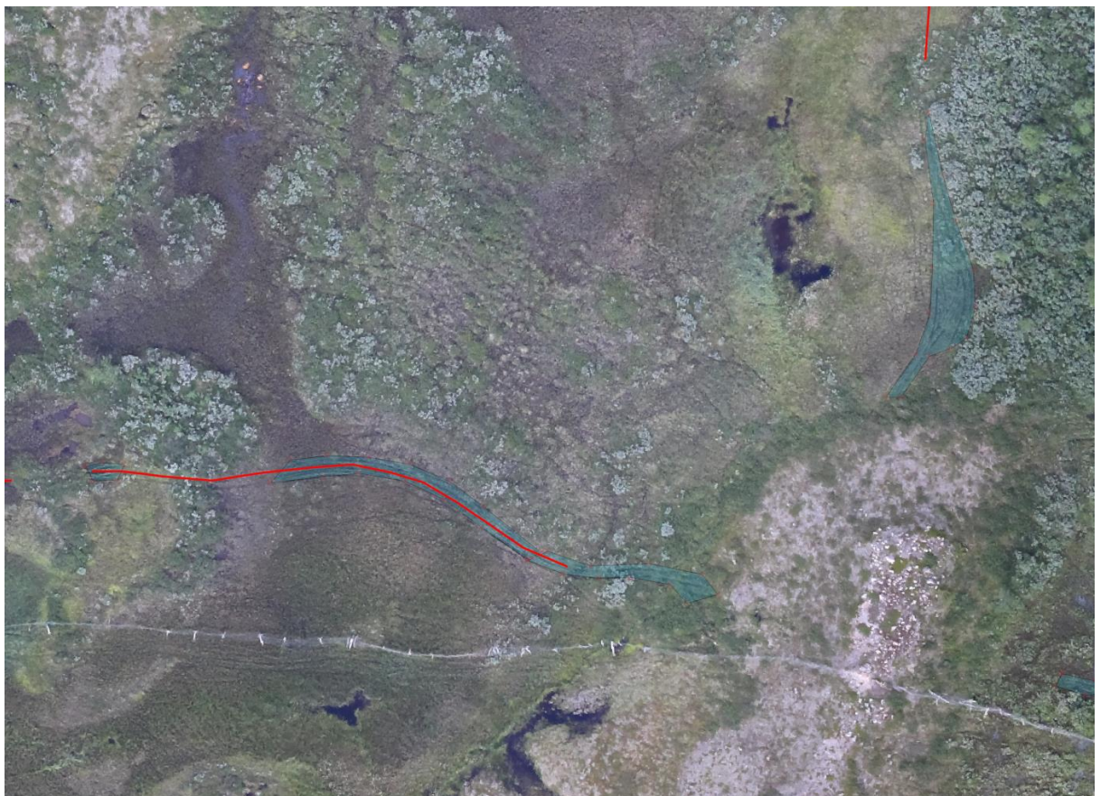
Fig. 22 Kjørespør avsatt nord for Havgajavri. Bakgrunnsbildet er fra RGB EOS-M kameraet. Oppløsning 10 cm
