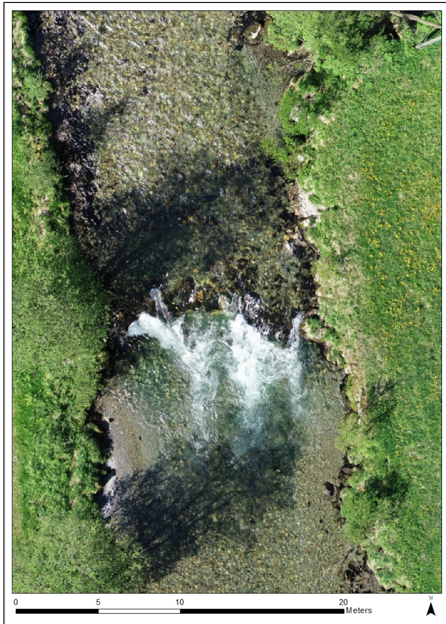
Figur 21. Unummerert terskel som ligger 155 meter nedstrøms terskel 4 bør få en dypere lavvannsrenne i midten og det bør legges ut flere blokkgrupper nedstrøms og oppstrøms terskelen for å dempe vannhastigheten.
