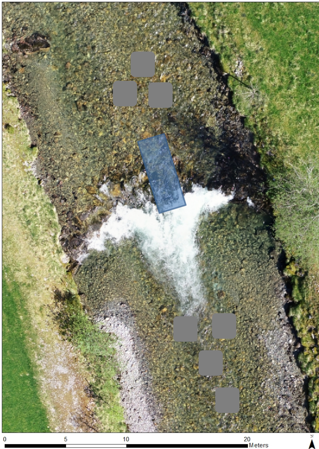
Figur 26. Prinsippskisse for hvordan man etablerer en lavvannsrenne i en terskel . Blokkene i midten, eller den delen av terskelen med det laveste naturlige punktet i tverrprofilen, plukkes ut og brukes som vist på figuren. Bredden i lavvannsrennen vil kunne variere, men vil typisk være fra 1 m til 2 m. Blokkene bør legges ut i de dypeste partiene ved lav vannføring. I enkelte tilfeller bør det suppleres med flere blokker stedegent for Vetlefjorden. Antallet blokker som legges ut avgjøres av hvor mange blokker det er i eksisterende terskel og behovet basert på skjønsmessige vurderinger på stedet. I utgangspunktet er prinsippet at desto flere blokker som legges ut, desto mer hydromorfologisk variasjon vil området og fiskene få. Legg gjerne flere blokker sammen som en blokkgruppe i elva, men også som bare enkeltblokker.
