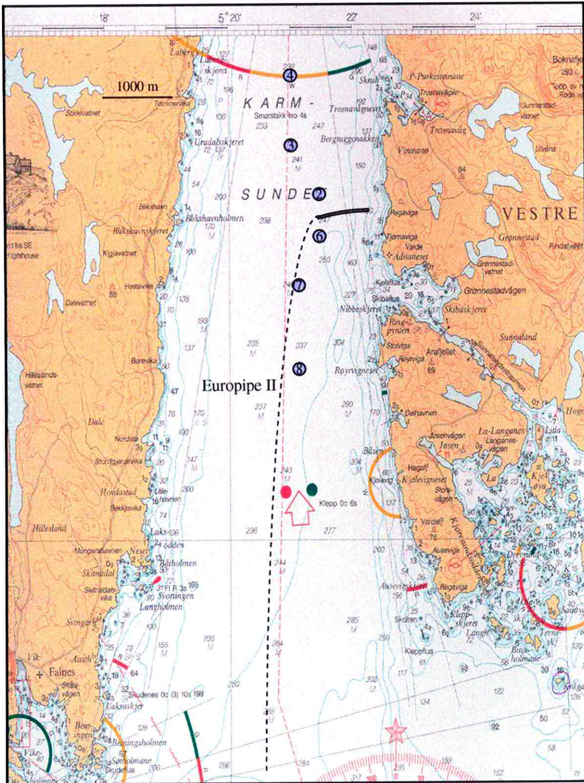
Figur 1. Oversikt over omtrentlig rørtrasé- og stasjonsplassering (Kar 2, 3, 4, 6, 7 og 8). Området av traséen hvor det skal mudres er markert med to parallelle streker.
