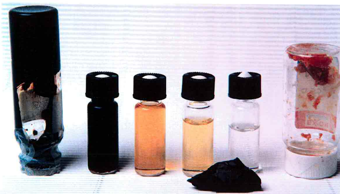
Figur 4. Illustrasjon av variasjon i petroleumprøver. Venstre til høyre: Viskøs biodegradert olje som er blitt tung, brun lett Norsk olje, kondensater med forskjellig innhold av polar forbindelser, tung nafta og voks. En skifer oljebergart vises i forgrunnen.
