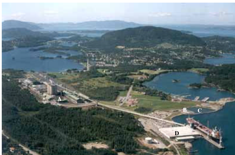
Figur 7. Oversiktsbilde over Husnes i sørlig retning. Bildet viser A: Verkshallene ved Sør-Norge Aluminium, B: sjøkantdeponiet for katodeavfall og anodestøv, C: sjøvannsdammen i SPL deponiet, D: fabrikkaien til SØRAL. (Foto: SØRAL).
