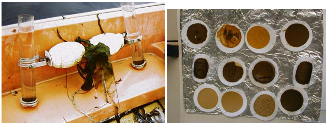
Figur 2. Bilde av en Limnos sedimentfelle og filter med sedimentert materiale fra Frafjord.
