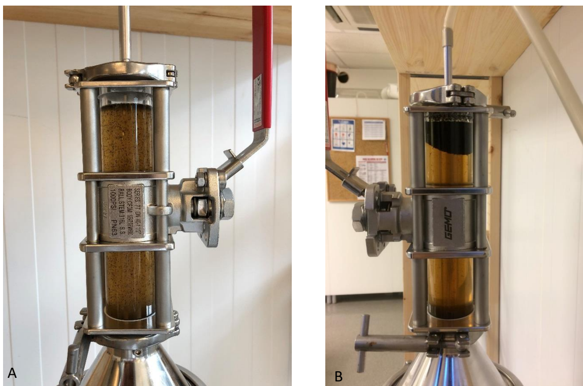
Figur 5. A). Toppkammeret til mikroplast sedimentseparatoren (MPSS, Hydrobios.de) isolerer partikler som flyter opp i ZnCl_2 , mens sand og tunge materialer ligger igjen på bunn. B) Prøven separerer over natten, innholdet i toppkammeret isoleres, og partikler renses videre før kjemisk identifisering av polymerer.
