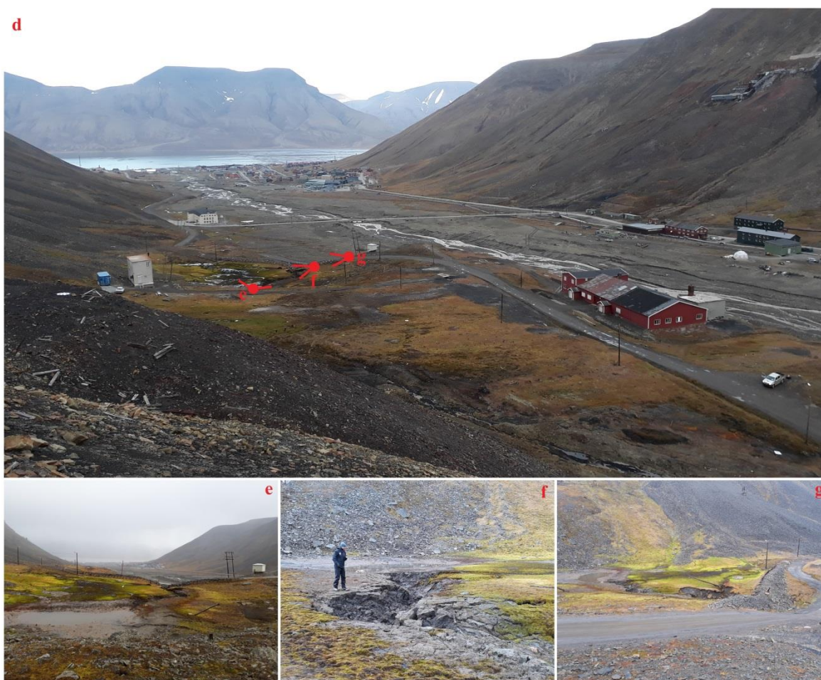
Figur 15: d) Oversiktsbilde av Sverdrupbyen tatt fra gruvedeponi. De røde brikkene viser detaljbilder e, f, g) av et område som kollapset og drenerte en liten innsjø.
