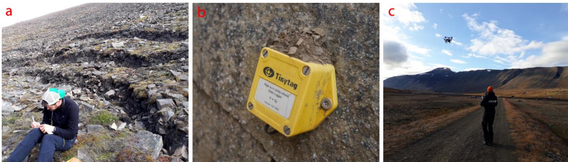
Figur 8: a) Feltundersøkelse rundt Longyearbyen, september 2017. b) Akselerometer som måler rystelser i en sprekke over Gruve II. c) Ubemannede fly kampanje.
