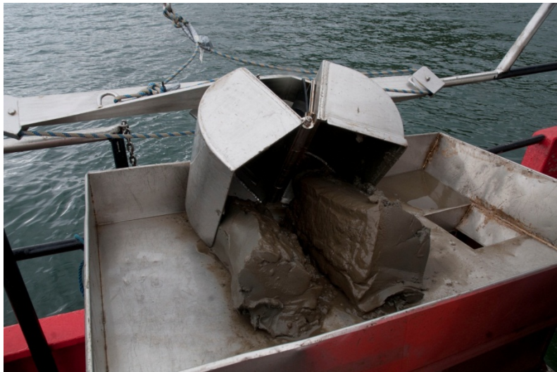
Figur 3: van Veen grabb benyttet for prøvetaking av sedimenter. Grabben samler et areal på 0.1 m 2 .
