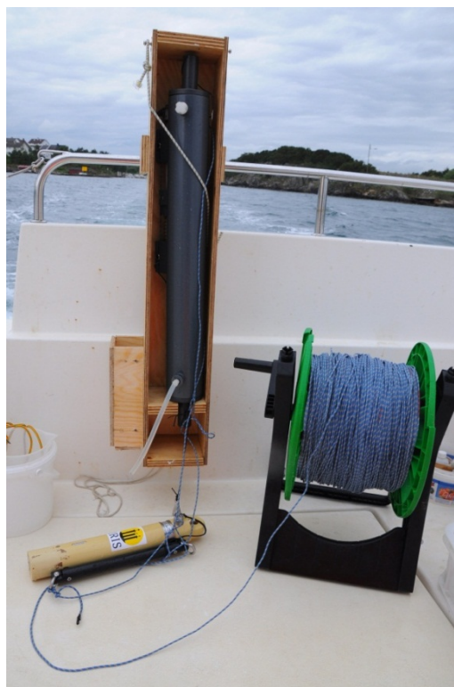
Figur 4: Niskin vannhenter og CTD SD200 som ble benyttet under prøvetaking.
