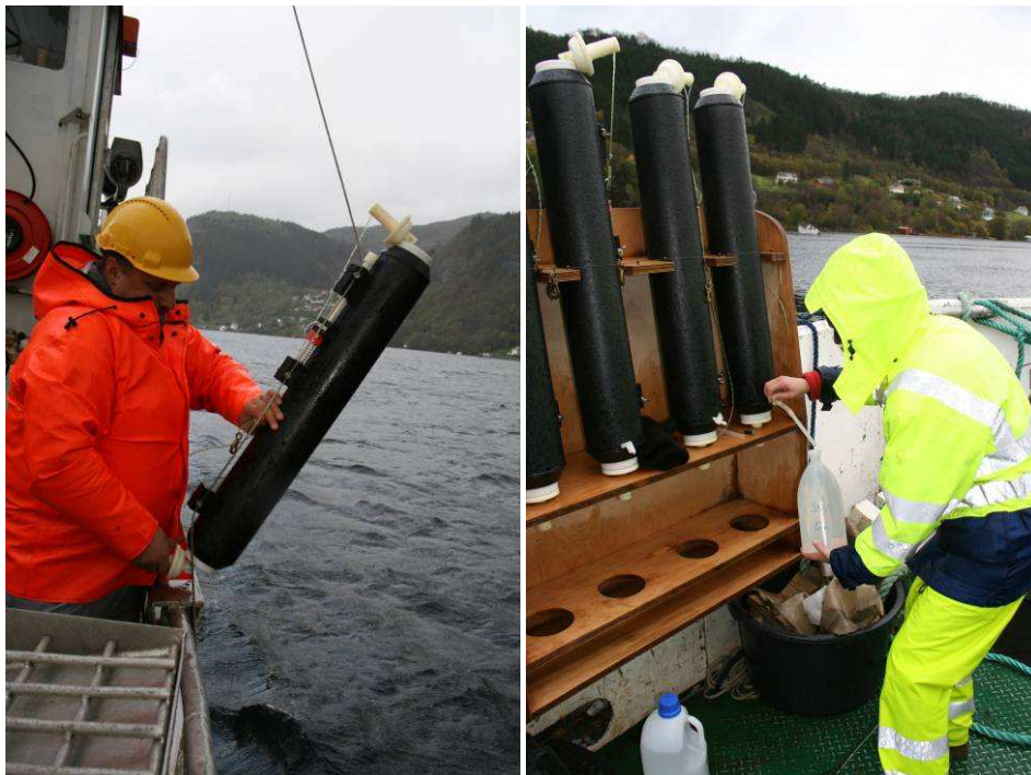
Foto. Innsamling av vann ved hjelp av Niskin vannhenter
