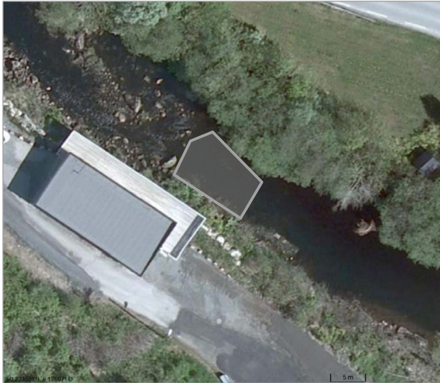
Figur 4. Lokaltet som er egnet til å legge ut gytegrus på i Hjelmelandsåna. Lokalteten er på utløpet av Steinslandsvatnet i den nedre delen av elva.
