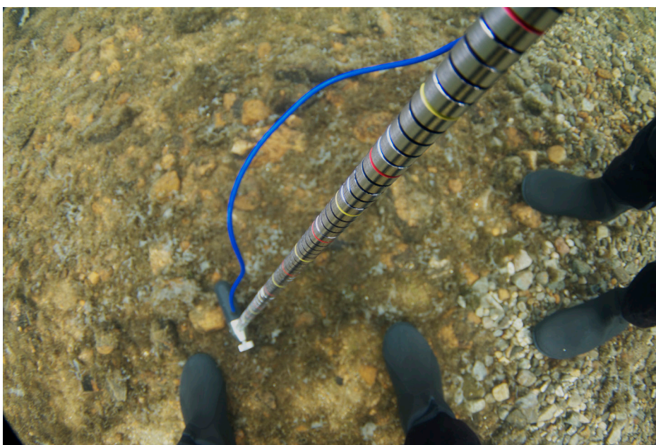
Vannhastigheten ble registrert ved bruk av en vannhastighetsmåler, type Valeport, på et utvalg av gytegroperne i Bjornesfjorden i 2007 og 2013.
