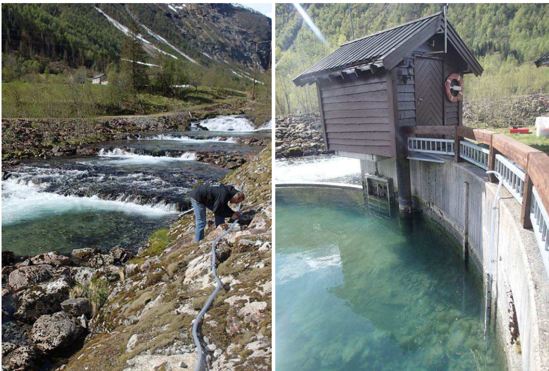
Figur 1 Målepunkt i restfeltet, (venstre bilde) og i kraftverksutløpet (høyre bilde). Sonden ligger i det perforerte metallrøret.
