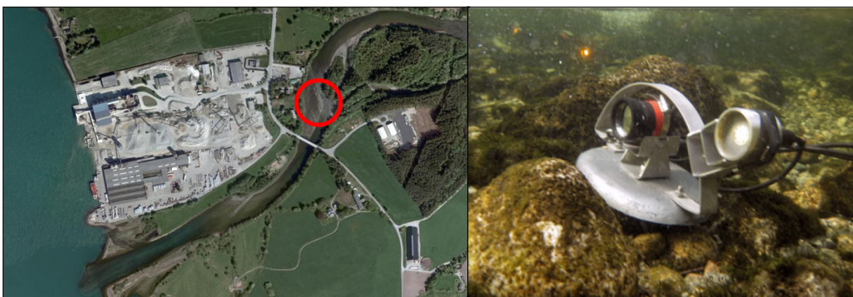
Figur 5: Plassering av videokamera i strykene ovenfor broen på Svadberg for overvåking av smoltutvandring fra Årdalselven.
