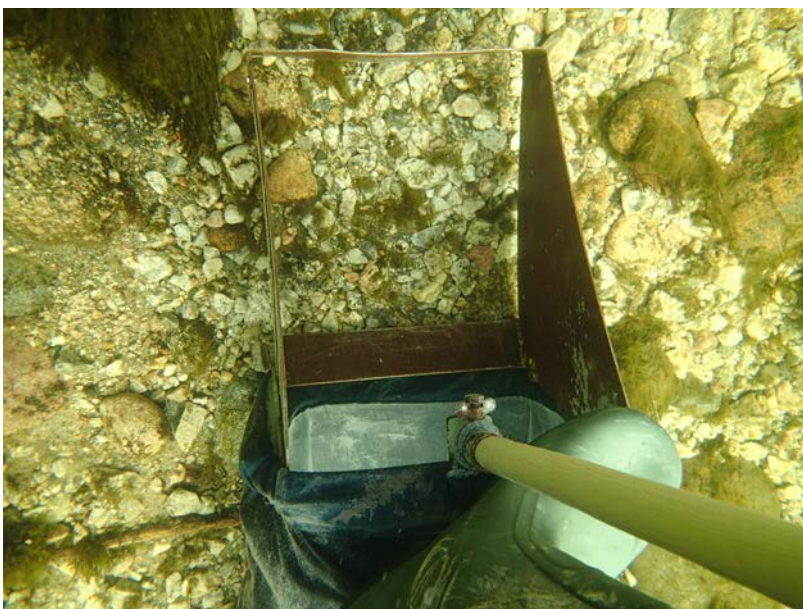
Figur 3. Substratet i bunndyrstasjon nedstrøms Brokke, sammen med surbersamplere. Dyrene innenfor metallrammen blir rotet opp og vannstrømmen fører dyrene inn i håvposen.
