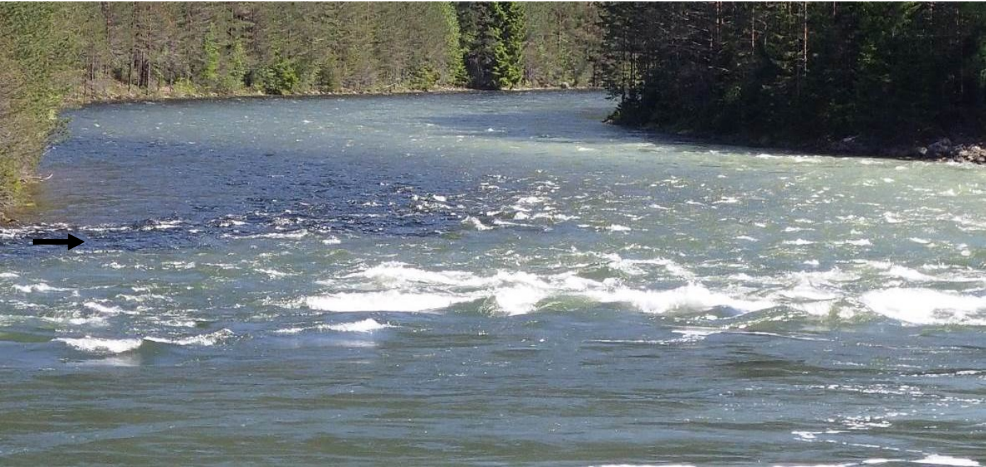
Bildet viser overmettet og blakket vann i Otra ved utløp Brokke kraftverk (28.05.2014). Vannet fra restfeltet er ikke overmettet (100 % metning) og er klart og mørkt (pil) mens vannet fra kraftverket er overmettet (166 % TGP) og blakket (gråhvitt). Blakkingen oppstår på grunn av mange små bobler – luft på vei ut av vannet.
