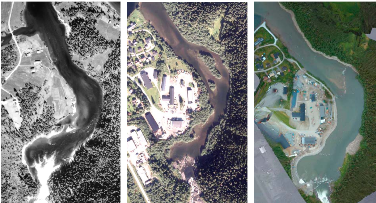
Fig. 127 Øvre del av Røssåga («Sjøforsløpet»). Bildet til venstre er tatt i 1953 (før utbygging), bildet i midten viser elva etter 60 år med minimal restvannføring (1-5 m 3 /s), mens bildet til høyre viser elva slik den er nå.
