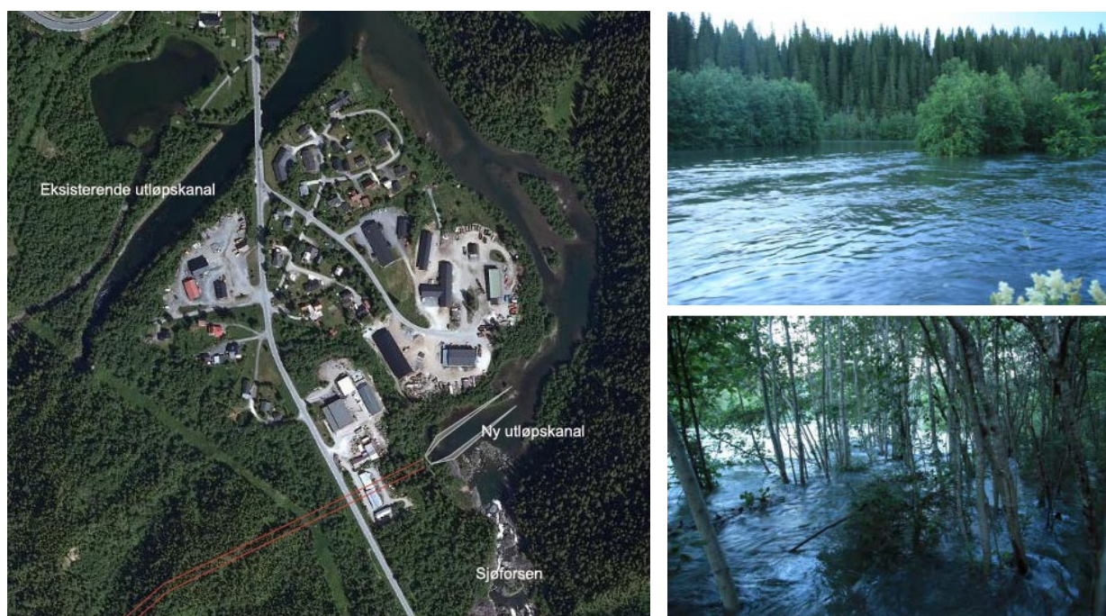
Fig. 128 Utgangspunkt for elverestaureringen; a) i forbindelse med rehabiliteringsplaner for det 60 år gamle Nedre Røssåga kraftverk ble det besluttet å bygge nytt kraftverk, der utløpet ville bli flyttet øverst i tidligere anadrom del av elva. b) og c) Det tidligere tørrlagte elveløpet ville se slik ut ved maksimal driftsvannføring (105 m 3 /s) i det nye kraftverket
