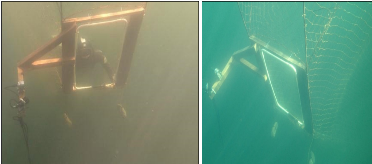
Figur 1. Prototypene for «videonota» hvor laks, sjøaure og rømt oppdrettslaks registreres ved kontinuerlig filming i det de passerer gjennom det åpne «vinduet» montert i enden på en modifisert kilenot eller størruse. I tillegg er rammen påmontert en egen antenne for å registrere laks og sjøaure som er merket med PIT-merker. Fisken kommer svømmende gjennom nota samme vei som dykkeren på bildet. På sikt vil rask og effektiv bildebehandling gjøre at en fortløpende kan få informasjon om hvor mye fisk som har passert gjennom redskapen f.eks. i løpet av siste døgn eller uke.
