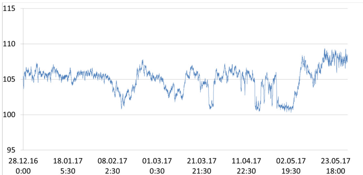
Figur 4. Gassmetning (% TGP) ved utløp Evanger kraftverk for januar – mai 2017.
