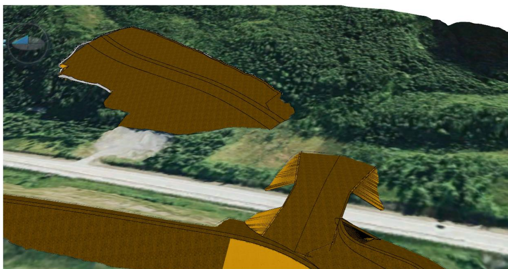
Fig 16. Skisse med terrengtilpassning av steinbrudd (Statens Vegvesen).
