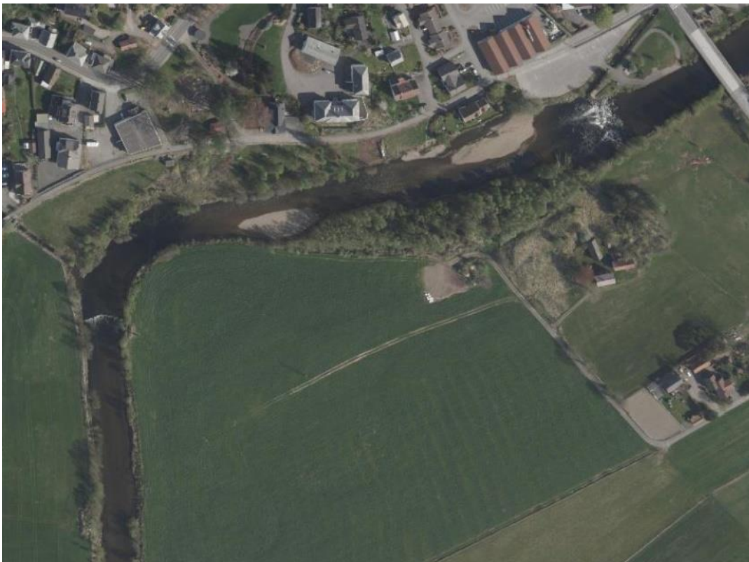
Figur 15. Flyfoto fra parti av Sokno ved hauge i Dalane i 1969 (øverst) og 2014 (nederst). Bildet viser hvordan elveløpet har blitt snevret inn og sideløp avstengt. Bildet viser også de to tersklene i Sokno.
