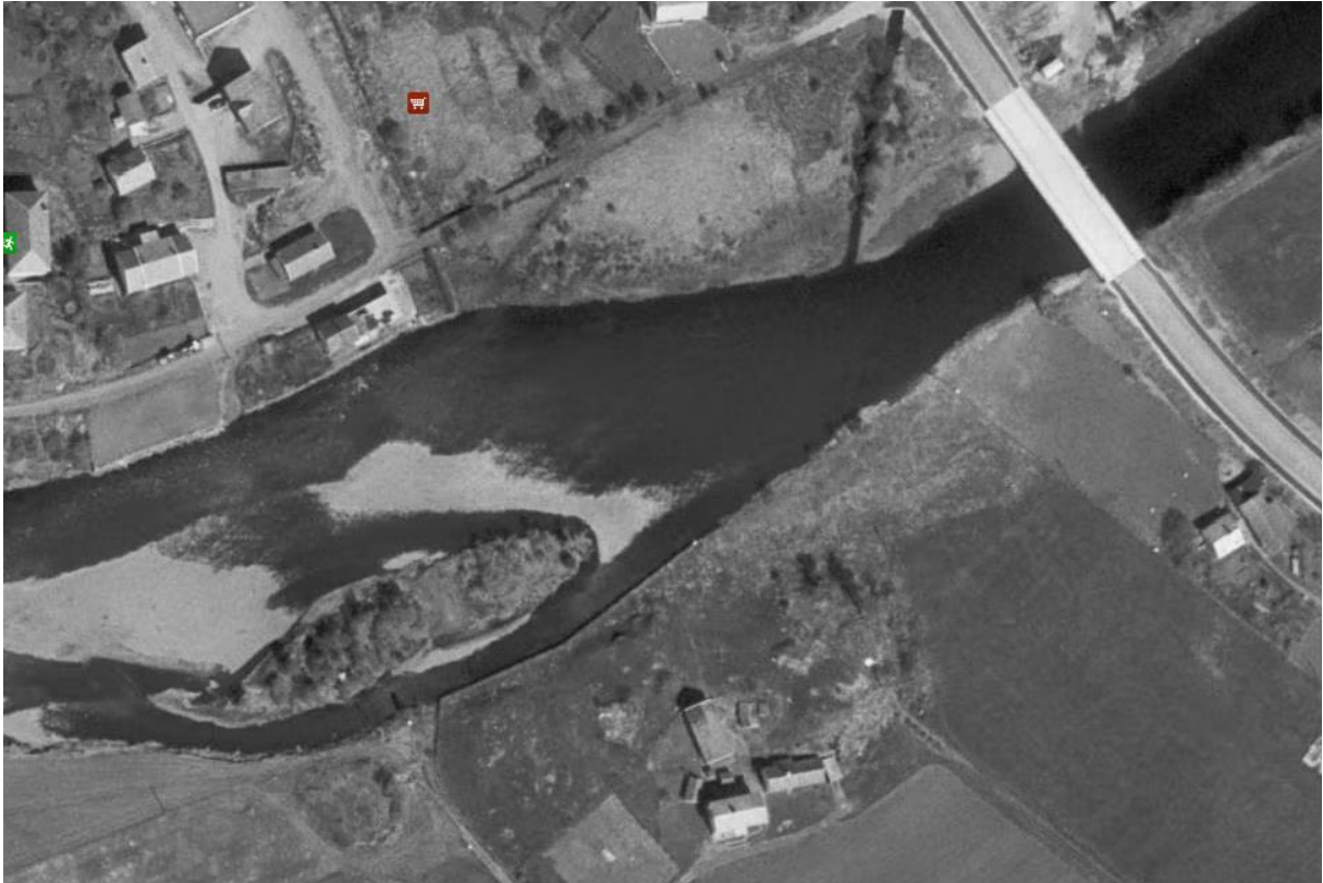
Figur 60. Flyfoto tatt i 1969 av samme område som vist i Figur 59. På dette tidspunktet var det ingen terskel, elveløpet var bredere i området og avløpstverrsnittet sannsynligvis langt større (foto: www.finn.no/kart ).
