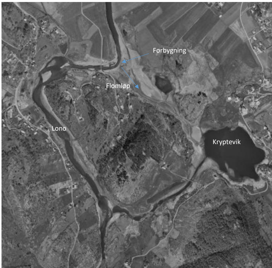
Figur 16. Flyfoto fra nedre del av Sokno fra 1969 (øverst) som viser et flomløp som har ledet vann inn i Kryptevik og inn i Sokno igjen ved utløpet av Lono. Det er mulig at dette også har vært et gammelt elveløp. Bildet viser også at det er laget en forbygning i svingen for å hindre at elven tar denne veien igjen.
