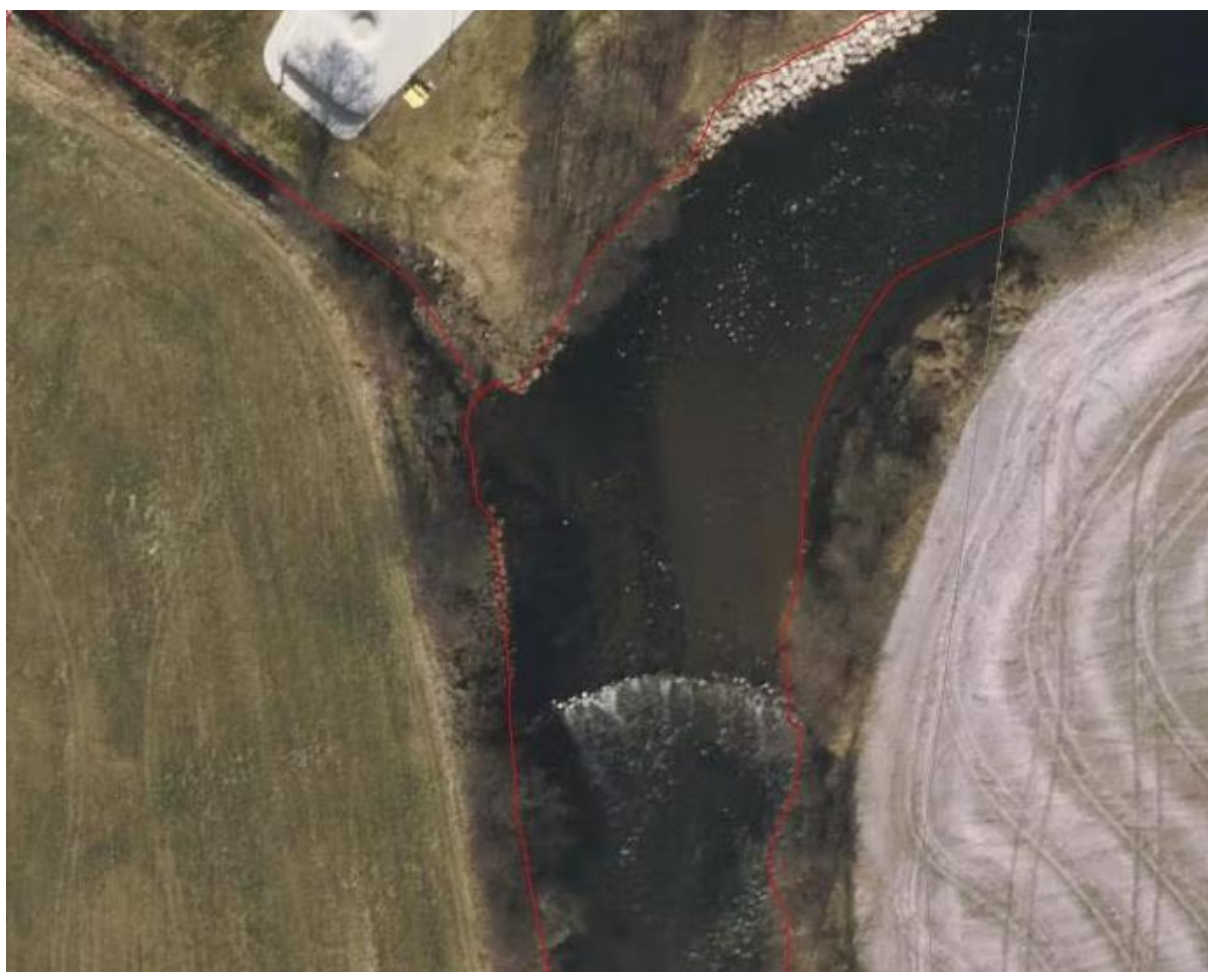
Figur 58. Den nederste av de to tersklene nær Hauge i Dalane. Denne terskelen har tilsynelatende ingen viktig funksjon og reduserer vannhastighet og fører til økt sedimentering oppstrøms (foto: www.finn.no/kart ).
