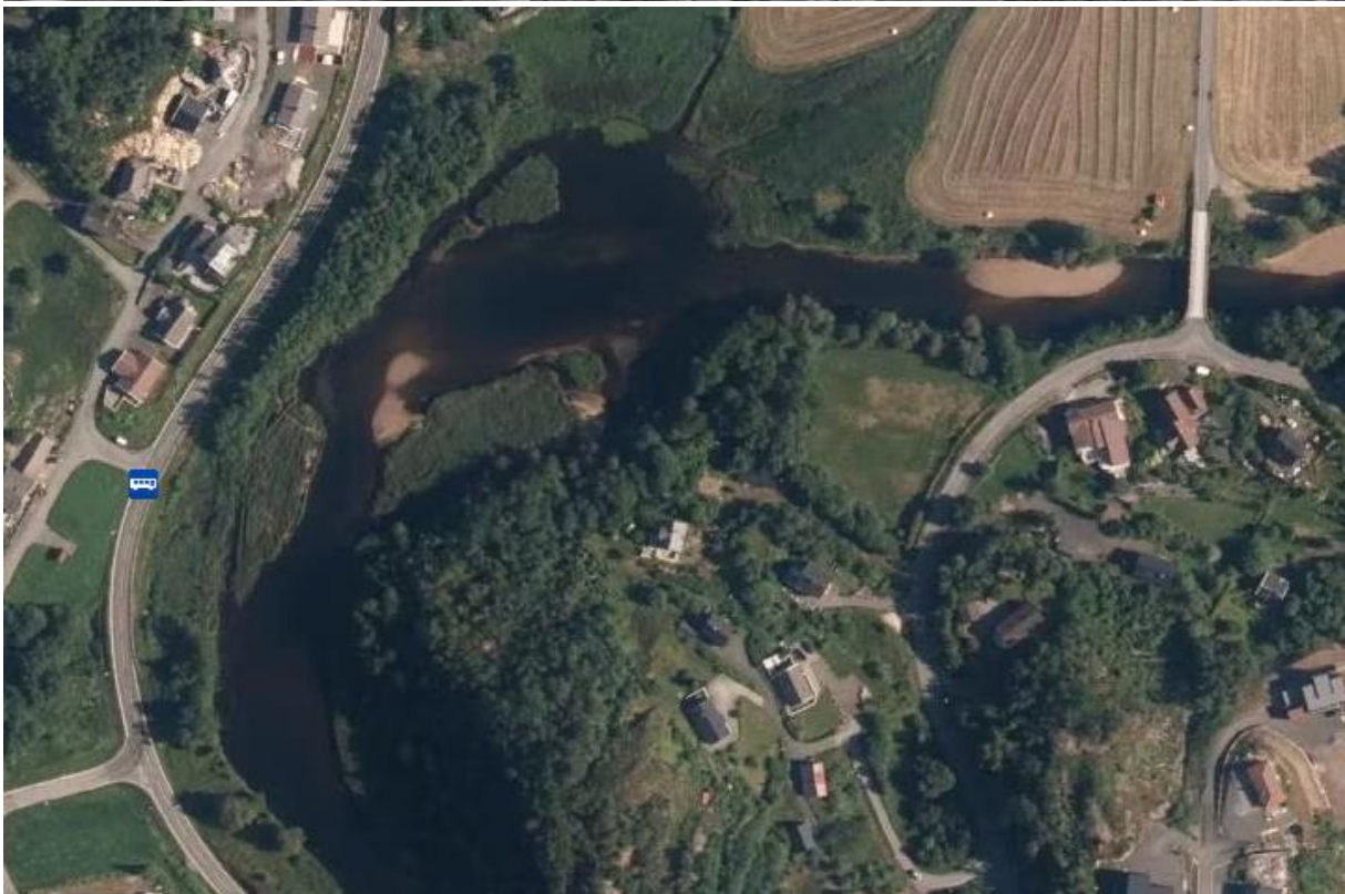
Figur 56. Område i Sokna hvor sandavsetninger over tid har skapt øyer i vassdraget. Øverste bilde er fra 1969 mens det nederste er fra 2019 (foto: www.finn.no/kart ).
