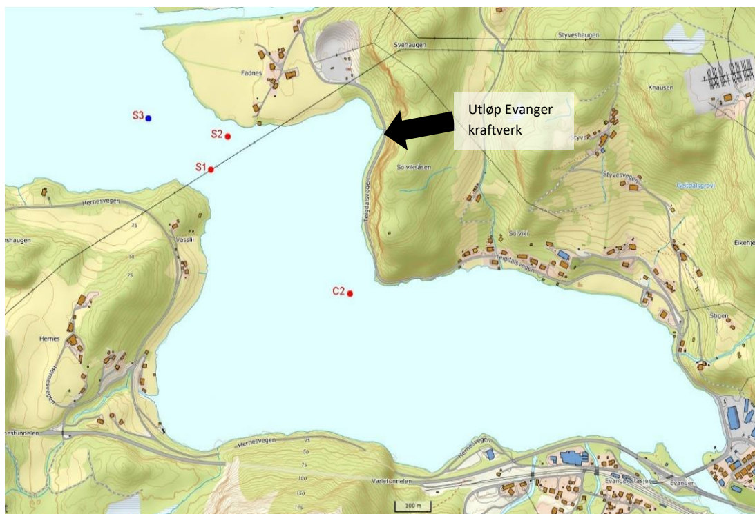
Figur 30. Oversikt over stasjoner med rigger for temperturloggere som har registrert temperatur på ulike dyp i den østre Enden av Evangervatnet i perioden 2019-2022.
