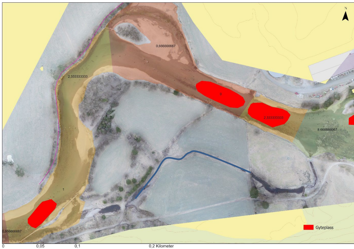
Figur 44: Tiltaksområde 7. Sideløp på sørsiden av elven faller tørt særlig i midten. Denne bør justeres slik at den er vanddekket også ved lavvannføring og finjustere habitater med kulp-stryk sekvenser og variert bredde (Pri 1). Utlegg av storsteingrupper i hovedelven (Pri 1). Kantvegetasjon (Pri 1).
