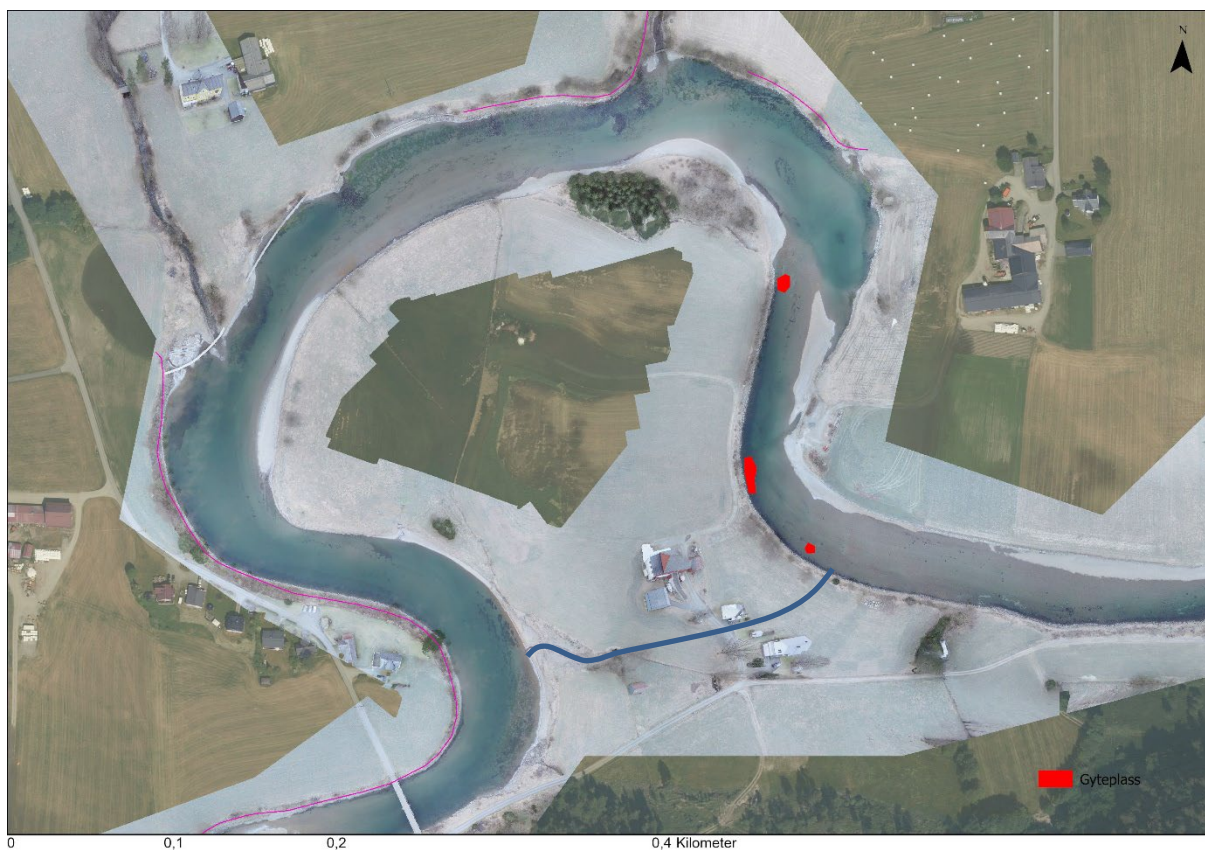
Figur 45: Tiltaksområde 8. Vurdere sideløp på sørside (Pri 1). Vurdere tiltak i tilløpsbekkene på nordside, den ene ser veldig lovende ut (Pri 1). Utlegg av døde trær og steingrupper i hovedelven (Pri 1). Kantvegetasjon (Pri 1).
