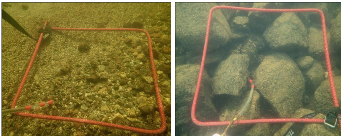
Figur 4. Skjulforhold for ungfisk måles ved å kvantifisere antall og størrelse på hulrom i elvebunnen med en plastslange (substrat-o-meter) innenfor en rute på 0,25 m 2 . Slangen har røde markører som brukes til å måle størrelsen (dybde) av hulrommene. Eksempel på skjulmålinger i substrat med mye fin grus og sand hvor det ikke finnes hulrom, og dermed svært lite skjul (t.v.), og i substrat med stein/blokk som gir mye skjul (t.h.).
