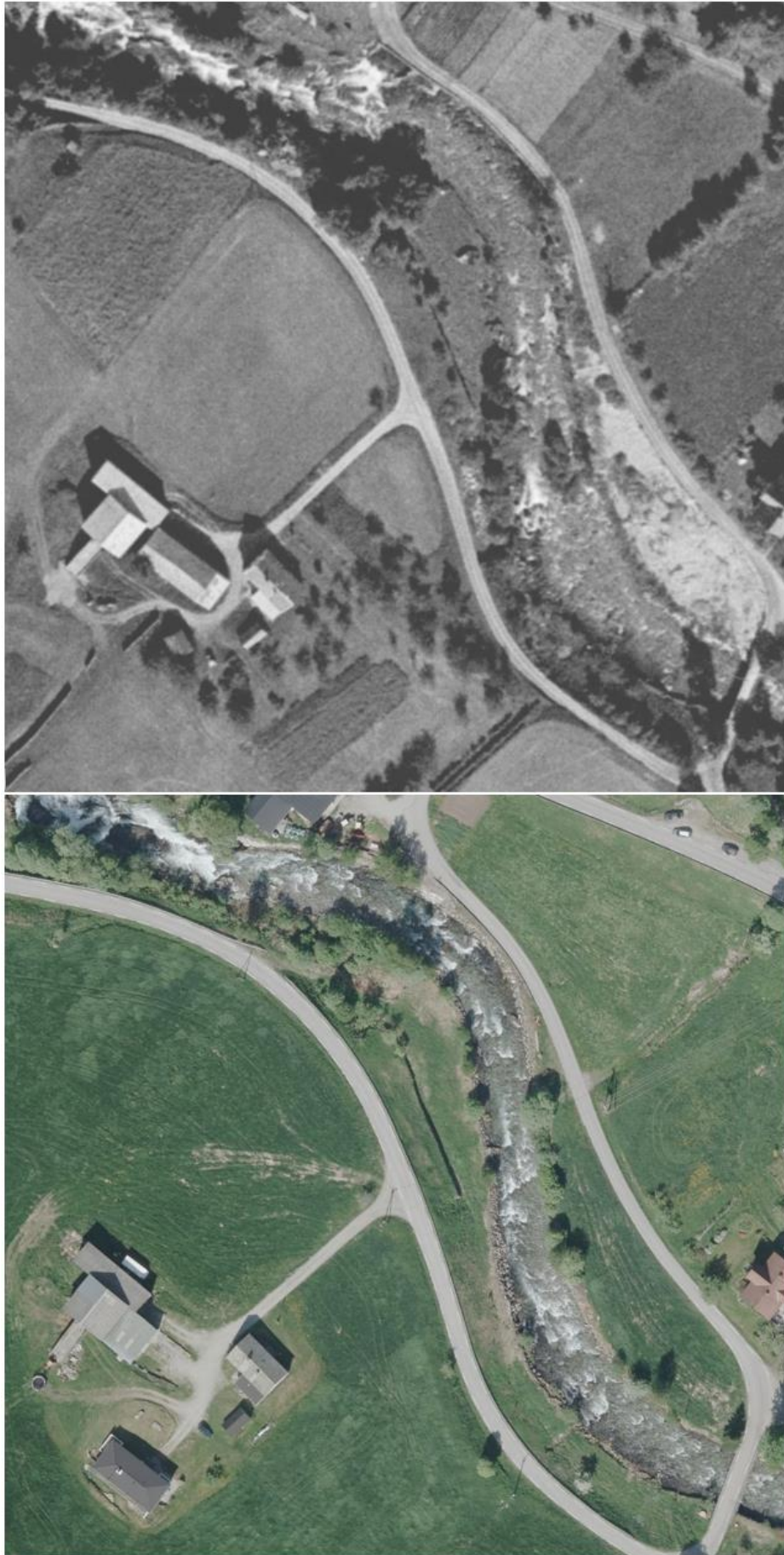
Figur 7. Flyfoto av Norddalselva i 1976 før forbygning (øverst) og i 2018 etter forbygning (nederst) ( www.norgebilder.no ).
