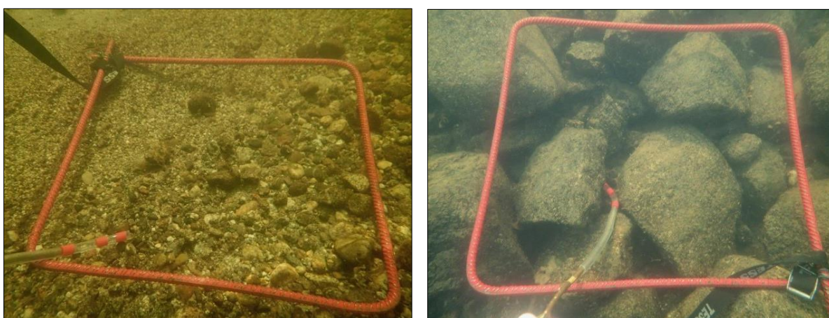
Figur 5. Skjulforhold for ungfisk måles ved å kvantifisere antall og størrelse på hulrom i elvebunnen med en plastslange innenfor en rute på 0,25 m 2 . Slangen har røde markører som brukes til å måle hulrommenes dybde. Eksempel på skjulmålinger i substrat med svært lite skjul (t.v.), og i substrat med stein/blokk som gir mye skjul (t.h.).
