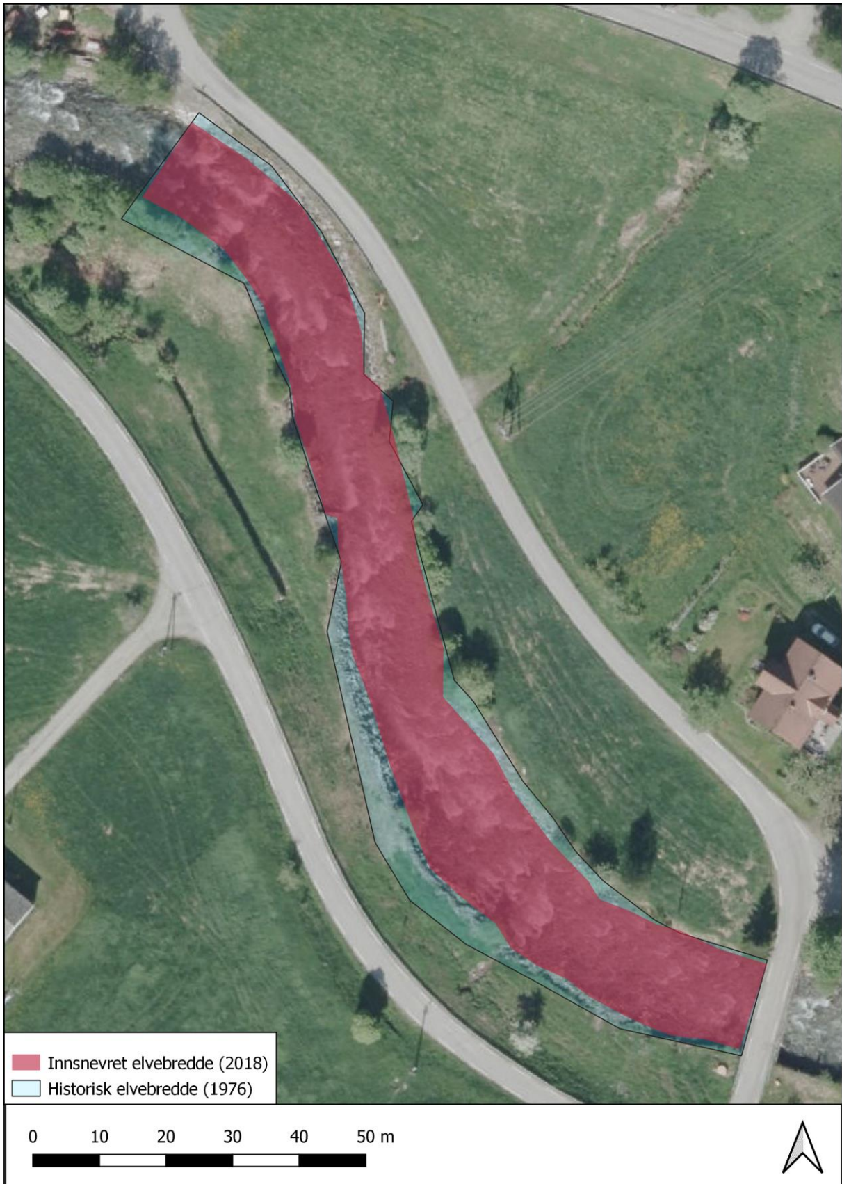
Figur 8. Elvebredden før og etter forbygninger. Rødt viser elvebredden i 2018, mens det blå polygonet viser elvebredden i 1976.
