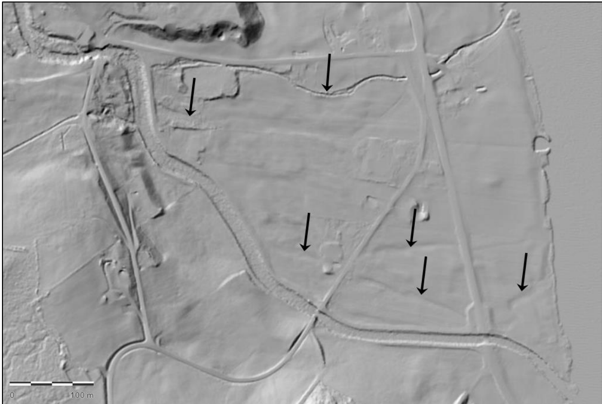
Figur 62. Laserscan av terrenget avslører det som sannsynligvis er en rekke gamle elveløp, som i dag er tørrlagt og avstengt fra Laurdalselva (fra hoydedata.no ).
