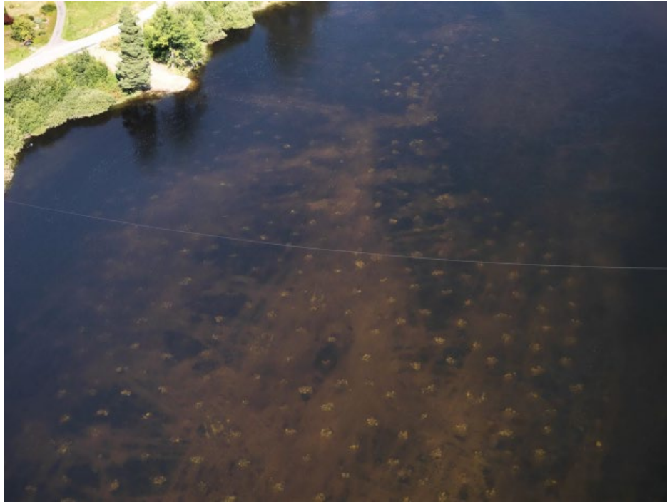
Figur 67. Dronefoto som viser blokkgruppene lagt ut sommeren 2020 på elvebunnen ved Espeland i Nidelva. Bildet er hentet fra Terrateknikk sin rapport 35 – 2020.
