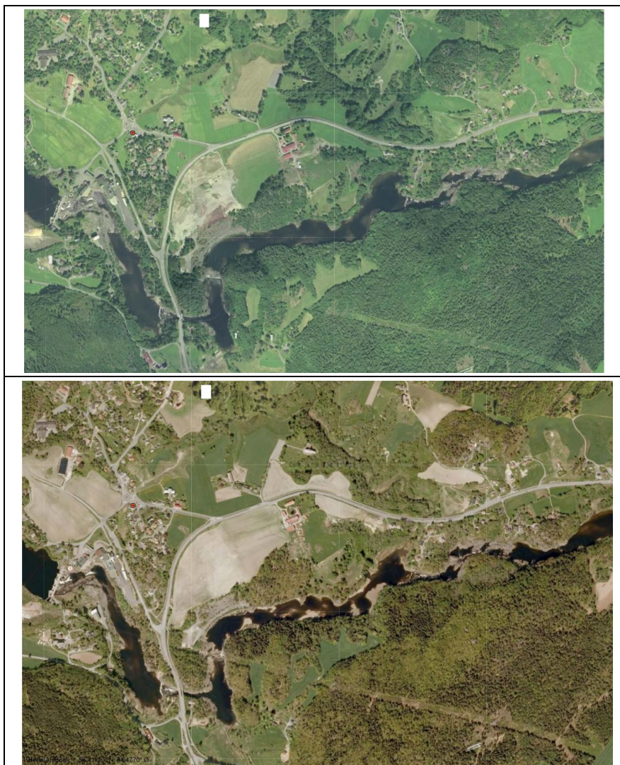
Flyfoto av minstevannføringsløpet mellom Rygene og Helle før (øverste bildet) og etter rivningen av de to tersklene i 2007 (nederste bildet). Flyfotoene er hentet på Finn.no.
