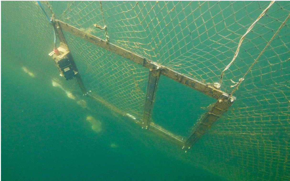
Figur 140. Kilenota på Trengereid med åpningen plassert på siden i fangstrommet. Kamera fra Mohn Technology er montert på en spesialbygget ramme hvor størrelses på åpningen ut fra nota kan modifieres. Kilenota på Trengereid er ca 5 m dyp og har et ledegarn fra land på ca. 60 m.
