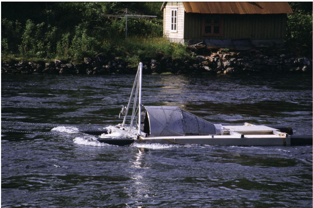
Foto 3. Smoltskruen i drift i Bolstadhølen. Smolten fanges inn i trommelen i front og holdes i et oppbevaringskammer synlig på bakre del av flåten.
