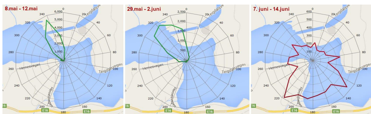
Figur 3.42. Stasjon B2, strømmåling. Gjennomsnittlig vanntransport ( m^3/m^2/dag ) i øvre vannlag (3-4 meters dyp) for ulike perioder. Målinger utført med akustisk profilmåler (ADCP, Nortek).
