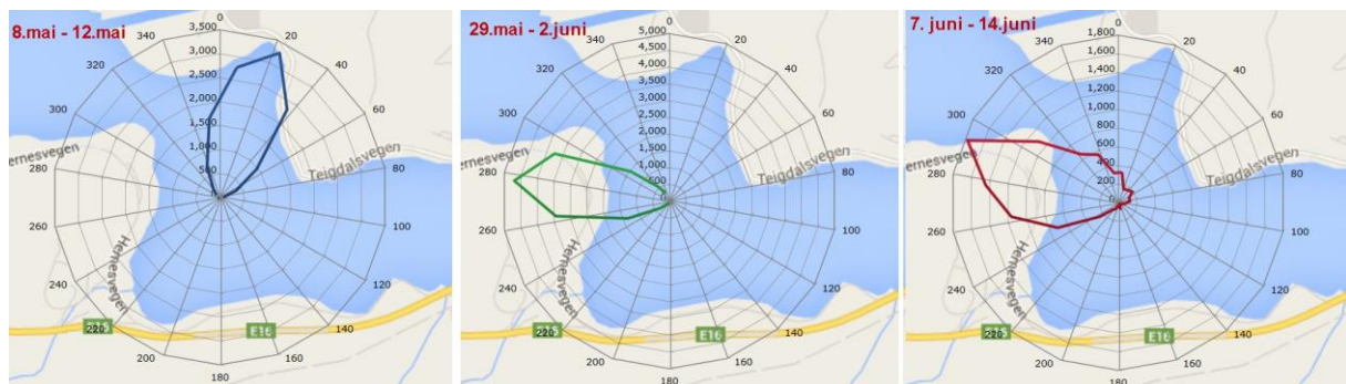
Figur 3.40. Stasjon C4, strømmåling. Gjennomsnittlig vanntransport ( m^3/m^2/dag ) i øvre vannlag (3-4 meters dyp) for ulike perioder. Målinger utført med akustisk profilmåler (ADCP, Nortek).
