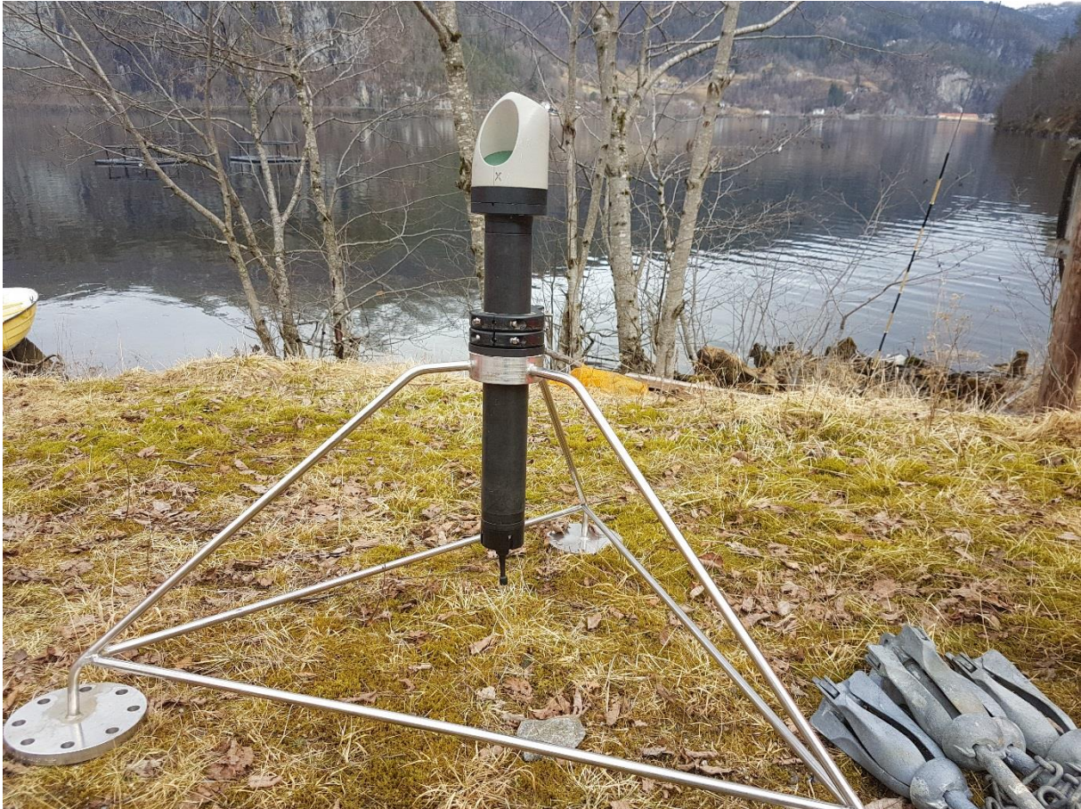
Figur 2. 6 ADCP (akustisk profilerende dopplerinstrument, Nortek) montert i bunnramme. Instrumentet var innstilt til å måle strømretninger og –hastigheter for hver meter oppover i vannsøylen.
