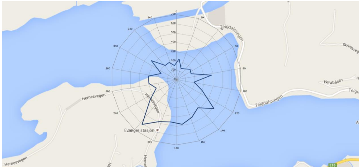
Figur 3. 18. Stasjon B2. Vanntransport (relativ fluks) registrert i perioden 6-14 juni, øvre vannlag (2-3 meters dyp).
