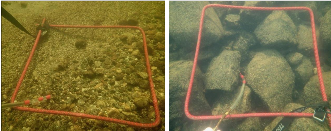
Figur 6. Skjulforhold for ungfisk måles ved å kvantifisere antall og størrelse på hulrom i elvebunnen med en plastslange (substrat-o-meter) innenfor en rute på 0,25 m 2 . Slangen har røde markører som brukes til å måle størrelsen (dybde) av hulrommene. Eksempel på skjulmålinger i substrat med mye fin grus og sand hvor det ikke finnes hulrom, og dermed svært lite skjul (t.v.), og i substrat med stein/blokk som gir mye skjul (t.h.).
