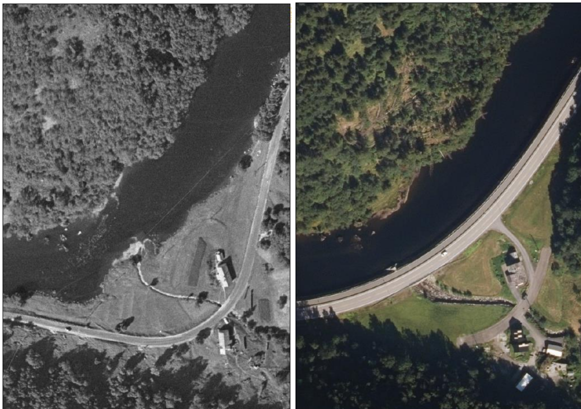
Figur 48. Elvestrekning i Tysseelva hvor veibygging har ført til homogenisert habitat og forbygningene er vertikale murer med lite skjul. T.v. 1965, t.h. 2020.
