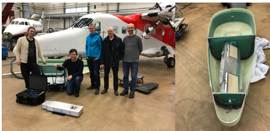
Figur 5: A) Ansatte fra NORCE, FFI og BAM i forbindelse med testmontering av radar i podden i BAM sine lokaler i Norköping i 2017. B) Radaren montert inn i podden med sender og mottaker antennene godt synlig.
