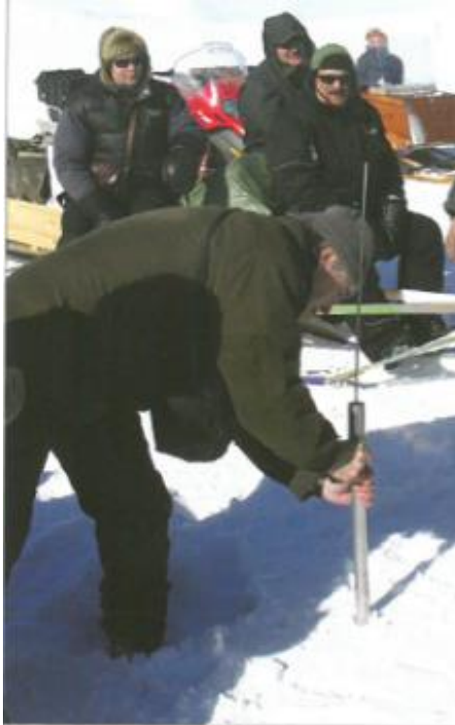
Figur 4. Hardhetsmåling med penetrometer.
