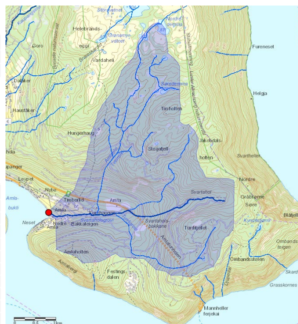
Figur 17. Nedbørfelt og lavvannsparemetere for Amlaelvi (nevina.nve.no).
