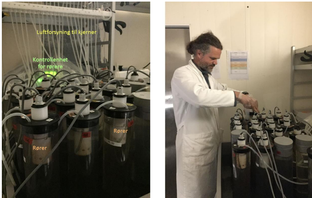
Figur 2. bilder av oppsettet for kjernene i klimarommet.
