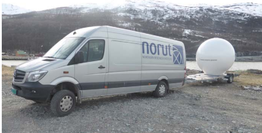
Fig. 3. Radar montert på tilhenger i beskyttende radom. Under operasjon stabiliseres tilhenger med støtteben.
