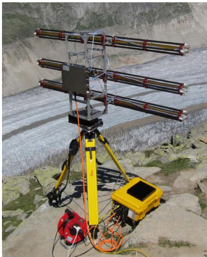
Fig. 1. Gamma Portable Radar Interferometer (GPRI). Systemet består av en senderantenne og to mottakerantennener som roterer for å belyse et område (Werner et al., 2012).
