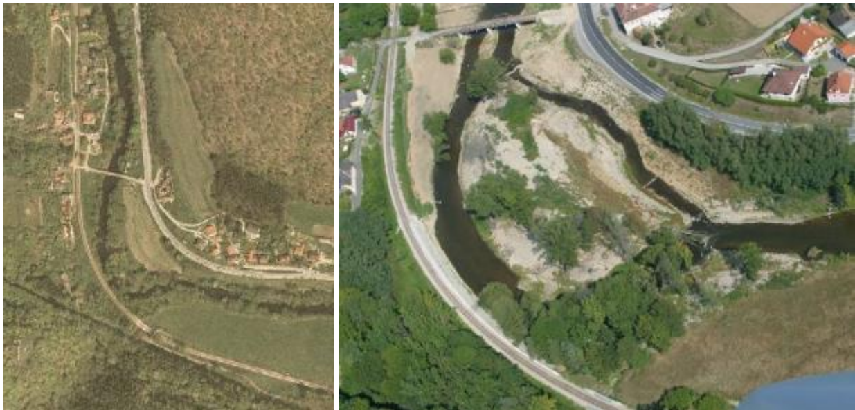
Figur 12. Restaurering av vassdrag og elveslette inkl. våtmark og myr. Eksempel Kamp/Østerrike. Bildet viser en utvidelse av elveløp og elveslette som oppsto i en flom og som ble opprettholdt etterpå som flomsikringstiltak for å redusere både erosjonsrisiko og oversvømmelsesfare for bebyggelsen rundt. En tilsvarende løsning kan anvendes for situasjonen i Figur 10
