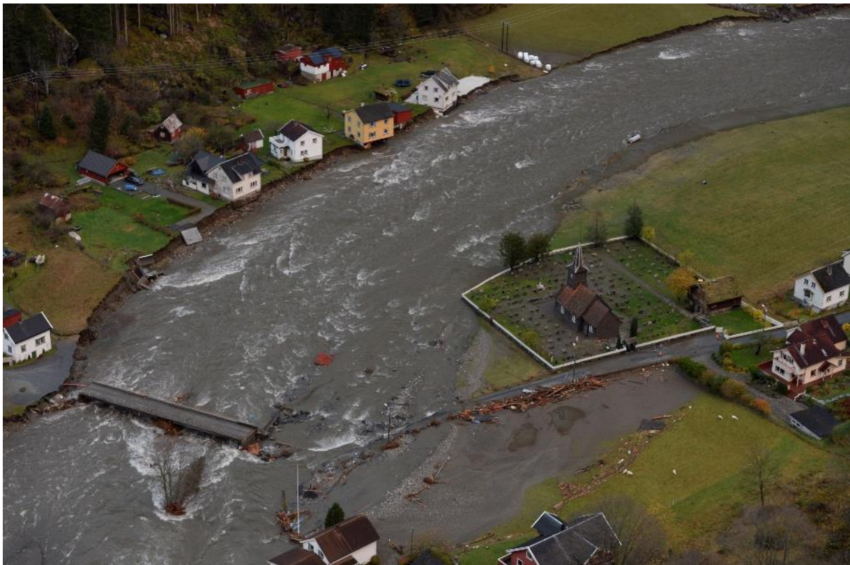
Figur 11. Superkritisk strømning på fluviale masser gir stor erosjons- og skadepotensial, her vist ved Flåm kirke i 2014
