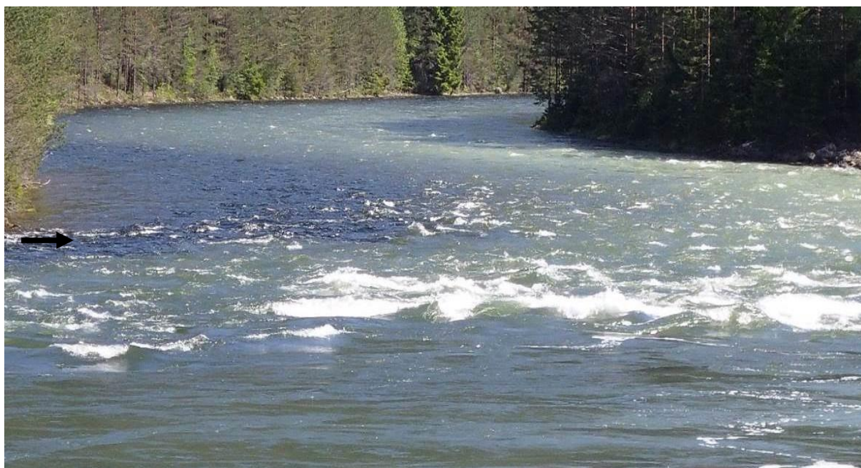
Figur 10. Bildet viser overmettet og blakket vann i Otra ved utløp Brokke kraftverk (28.05.2014). Vannet fra restfeltet er ikke overmettet (100 % metning) og er klart og mørkt (pil) mens vannet fra kraftverket er overmettet (166 % TGP) og blakket (gråhvitt). Blakkingen oppstår på grunn av mange små bobler – luft på vei ut av vannet.
