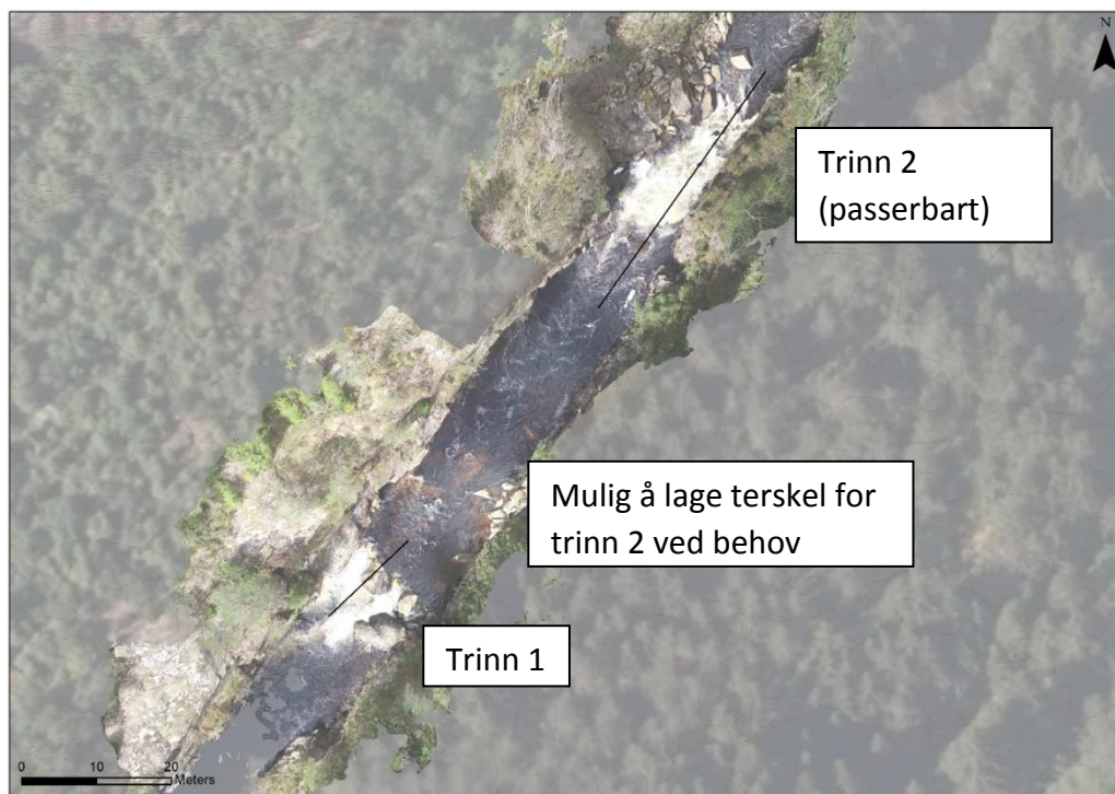
Figur 10. Kart over trinn 1 og 2. Ved behov kan det eventuelt lages en terskel ved å sprengre masser fra fjellsiden som legger seg på det grunne området like oppstrøms trinn 1. Dette vil heve vannspeilet i området og gjøre stryket lettere passerbart.
